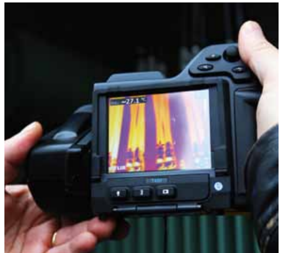
Lämpökuvauksella on mahdollista havaita palovaarallisia vikoja sähköasennuksissa
