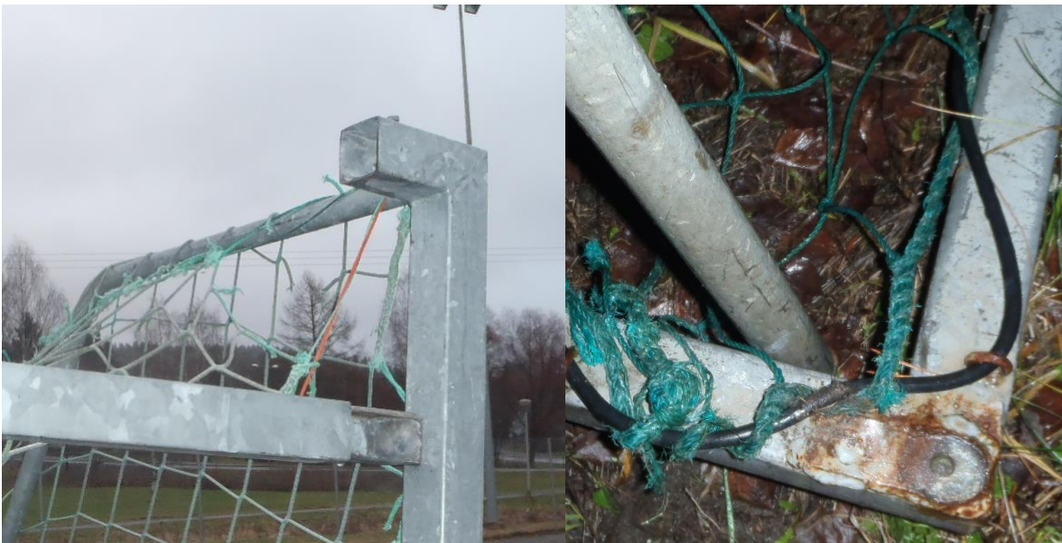
Kuvassa vasemmalla paikaltaan irronnut orsi ja oikealla irronnut takarautaan kiinnittyvä runkorauta.
