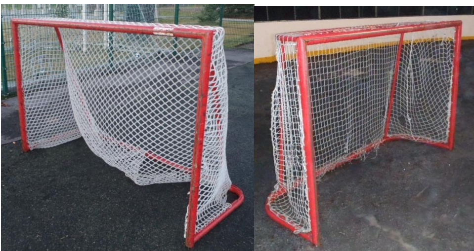
Jääkiekkomaalit voivat olla rakenteelta hyvin painavia, mutta samalla helposti kaatuvia. Vasemmalla oleva 28 kg painoinen maali kaatui 5 kg vedolla ja oikealla oleva 37 kg painoinen maali kaatui 7 kg vedolla.
