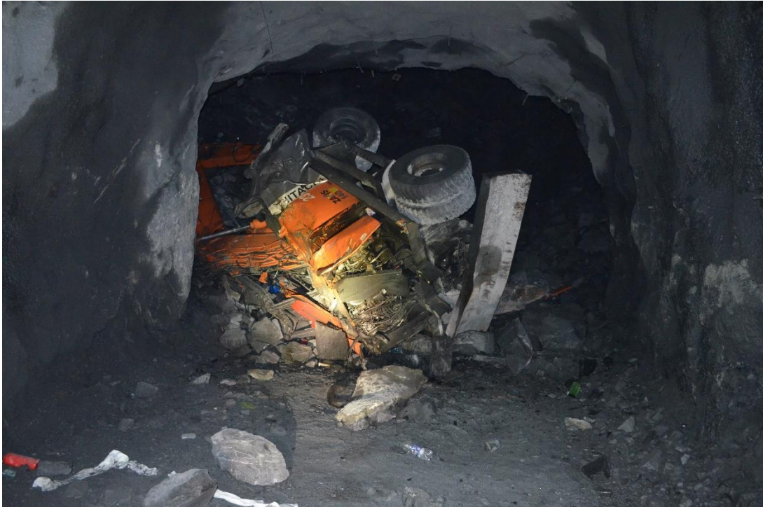
Kuva 6. Lastausperä 350, onnettomuudessa vaurioitunut kaivinkone. Kuva Tukes
