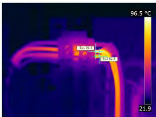
Kuva 42. Löystyneen riviliittinkytännän vaikutus johtimen ja liittimen lämpötilan nousuun (© Hannu Halminen, Bolden Harjavalta Oy).
