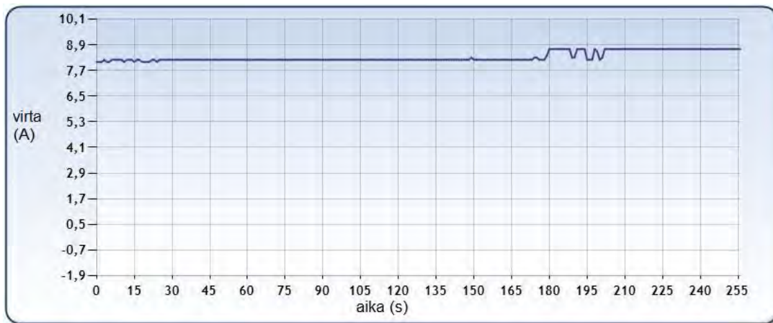
Kuva 65. Rinnakkaisvian ja maasulun ilmenemismuoto virtamittauksessa..
