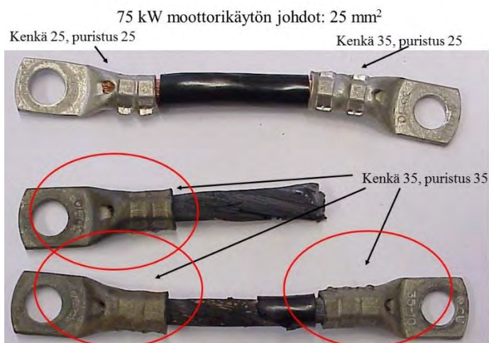
Kuva 27. Esimerkki väärän kokoisen työkalun käytön seurauksista puristettavilla kaapelikengillä (© Hannu Halminen, Bolden Harjavalta Oy).
