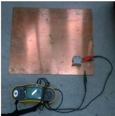
Kuva 67. Eristysresistanssin mittaus vikaantuneen kontaktorin vaiheen ja sen kuoren välillä.
