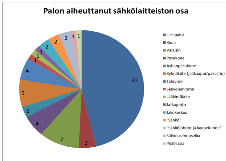
Kuva 17. Sähköpalokuoleman aiheuttaneet laitteiston osat selvityksessä tarkasteluvuosilta 2010–2014, tarkastelujakso 5 vuotta.
