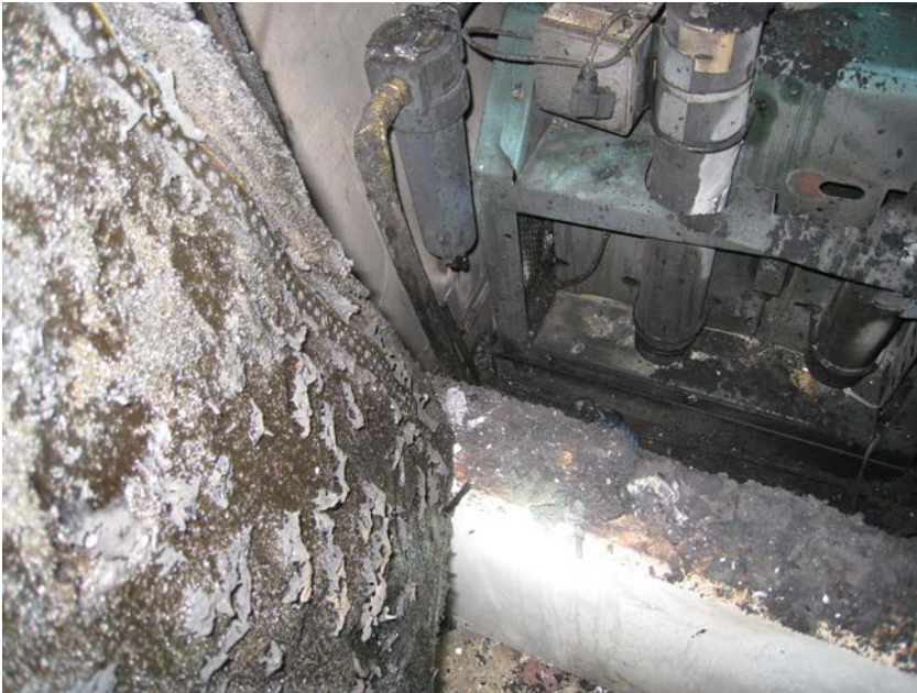
Kuva 6. Kompressorin palaneet öljysuodattimet
