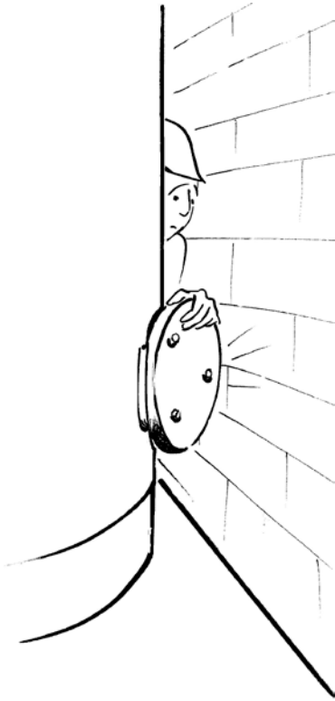
Kuva 4: Säiliön tarkastus. Säiliöt on sijoitettava niin, että ne voidaan tarkastaa ja pitää kunnossa.
