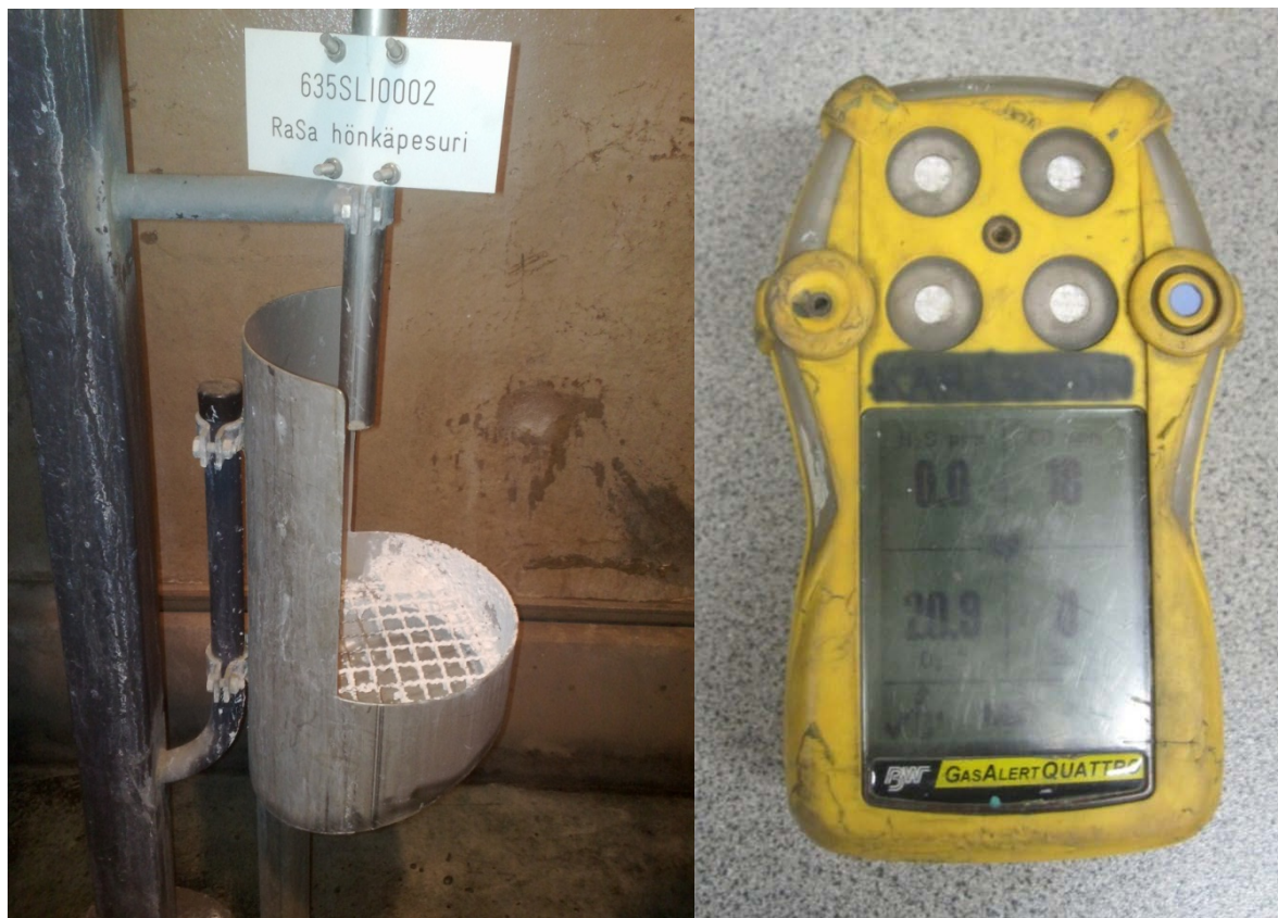
Kuva 3. Näytteenottopiste ja kannettava monikaasumittari.
