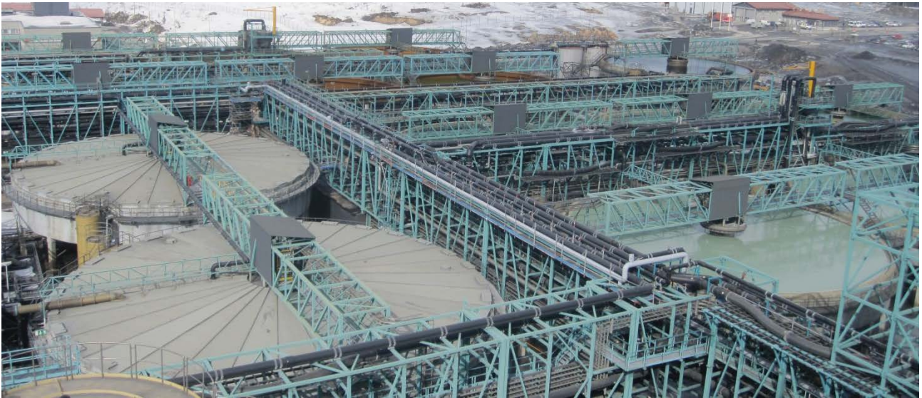
Kuva 10. Sakeuttimia. Osa sakeuttimista on katettu (kuvassa vasemmalla) ja yhdistetty hönkien keräilyyn ja osa on avoimia (kuvassa oikealla).
