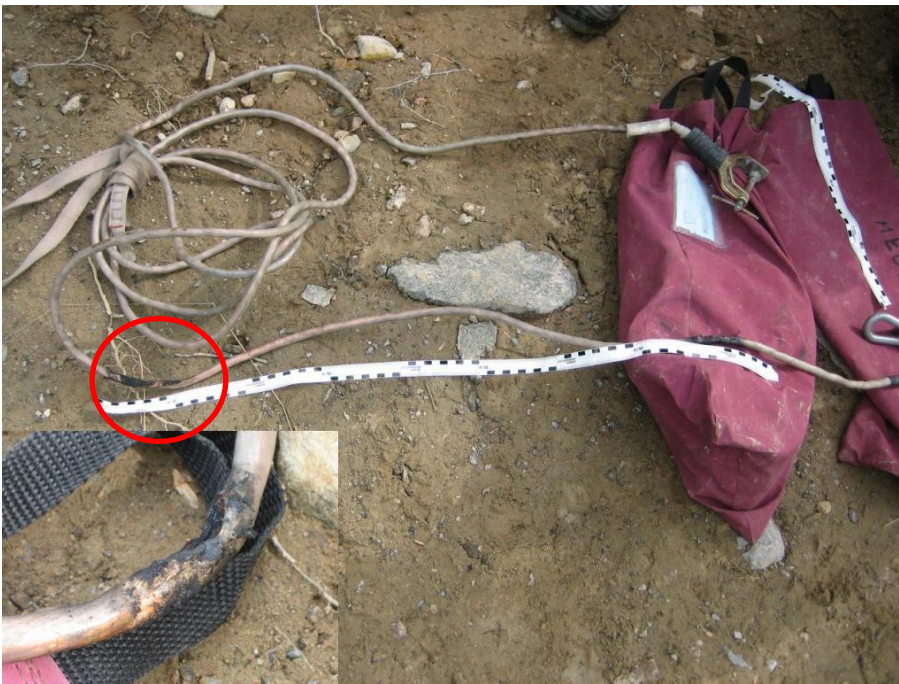
Kuva 6. Onnettomuustyössä käytetty työmaadoitusväline.
