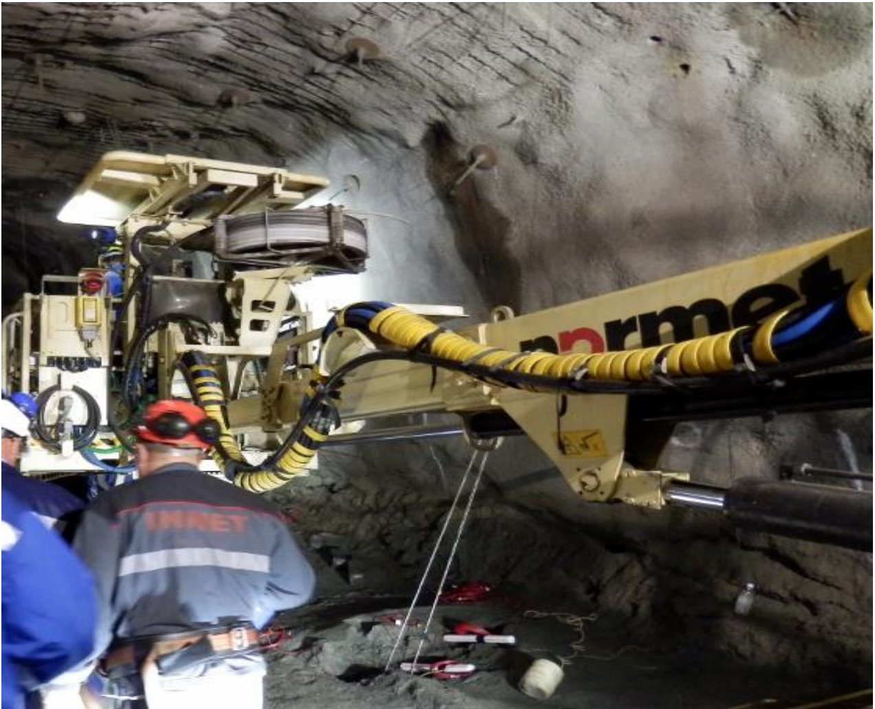
Kuva 1: Alakätisten panostustyö käynnissä Pyhäsalmen kaivoksessa 1 . Kuvassa näkyy ajoneuvon puomi.
