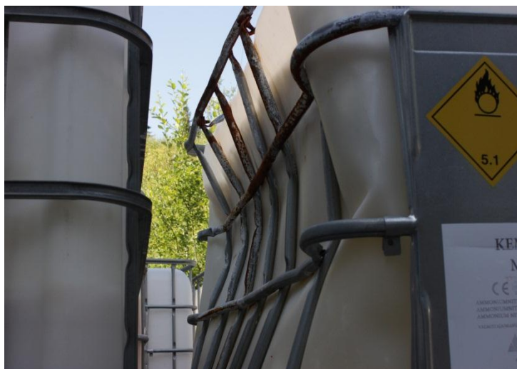
Kuvat 11 ja 12: Räjähdevaraston 312 piha-alueella olevia vaurioituneita IBC-räjähdejätepakkauksia.
