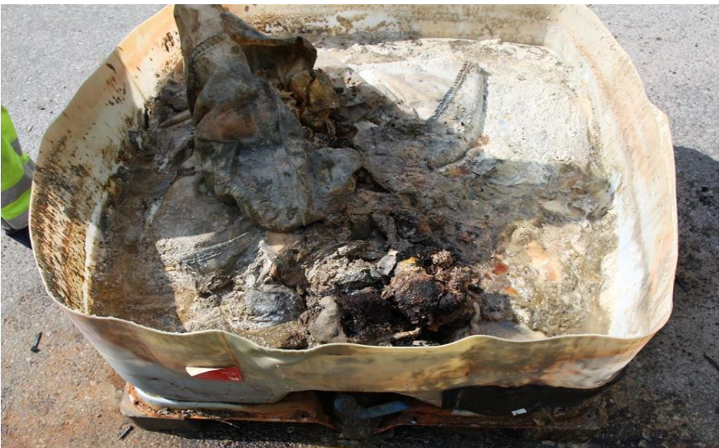
Kuva 7: Herkistetyn emulsion ja kiviaineksen seassa oli säkkejä, jotka sisälsivät matriisia. Kuvassa näkyy hanan myös läheisyydessä ollut hiiltymäkohta.
