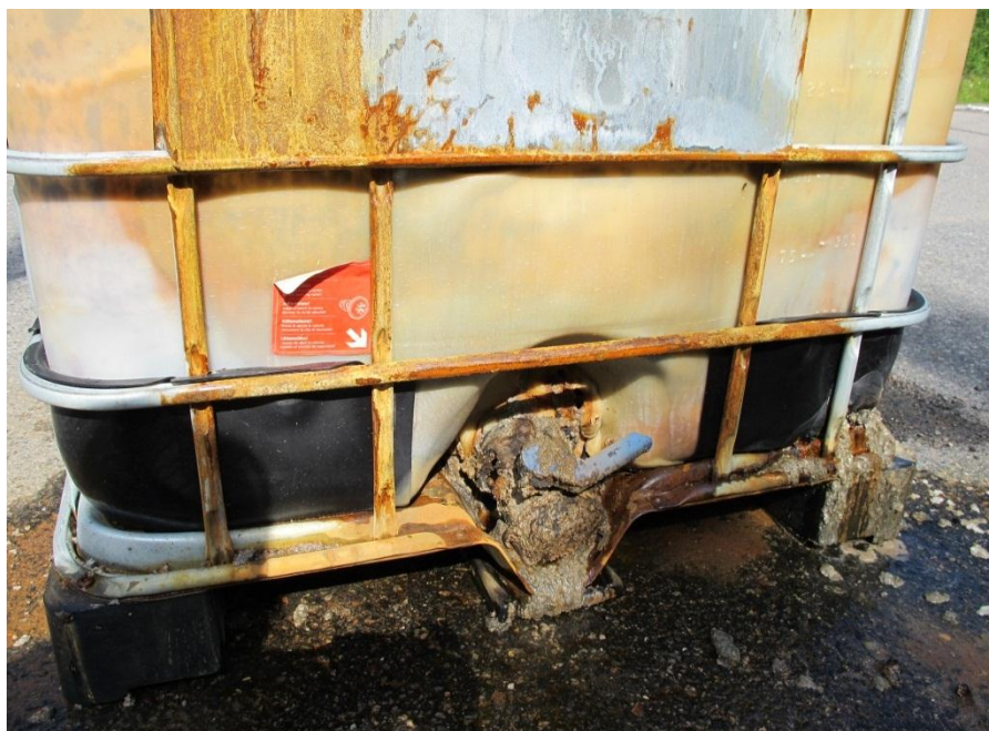
Kuva 5: Höyrynneen pakkauksen muovi oli sulanut lämmön vaikutuksesta kulmista ja hanan ympäriltä.
