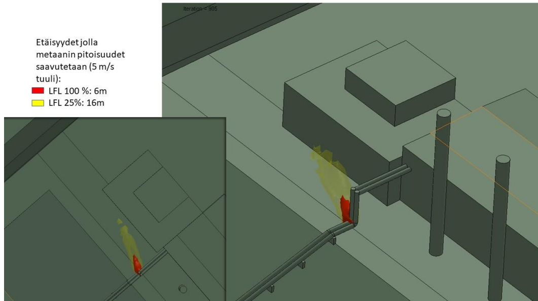
Kuva 6. Kaasun vuoto putkisillalta laipasta, räjähdysvaaralliset alueet (LFL 100 % ja LFL 25 %) 5 m/s tuulen nopeudella.
