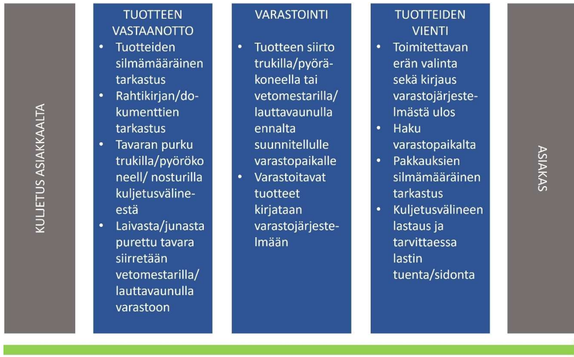
Kuva 6: Tuotteiden käsittely lattiavarastossa (kuljetusvälineen purku ja lastaus)
