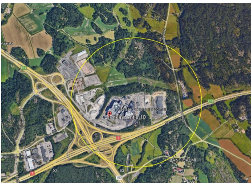
Kuva 21. Fenyyli-isosyanaatin AEGL3 30 min arvo karttapohjalla esitettynä. Leviäminen pihamaalle valuneesta n. 100 m 2 :n lammikosta.
