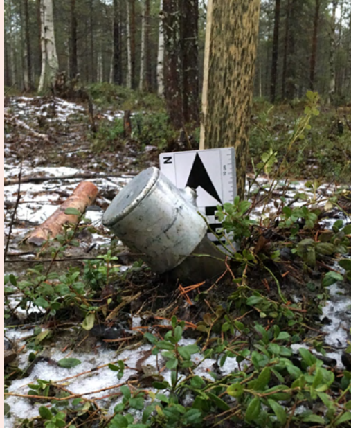
Sopiva maaputken korkeus on n. 10 cm. Kuva: GeoPool Oy.
