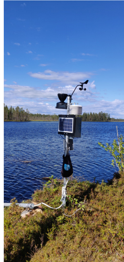
Mittausasema tekee havaintoja säästä ja pintaveden korkeudesta. Kuva: Mawson Oy.
