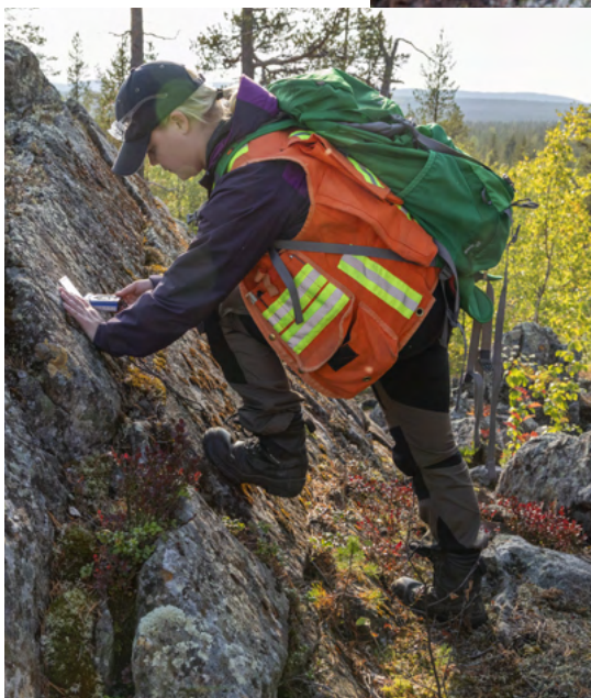
Maastokartoituksen yhteydessä tehdään havaintoja alueen kallioperästä ja otetaan tarvittaessa pieniä kiviläytöitä. Kuvat: AA Sakatti Mining Oy.
