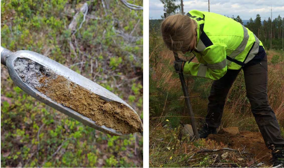
Auger-kairalla otettu maaperänäyte (vas.) ja käsin tehtävää maaperänäytteenottoa (oik.). Kuvat: GeoPool Oy.
