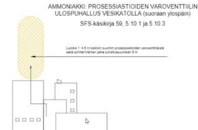
Kuva 1: Varoventtiilin ulospuhallus on suoraan ylös ja hattu päähän sadesuojaksi.
