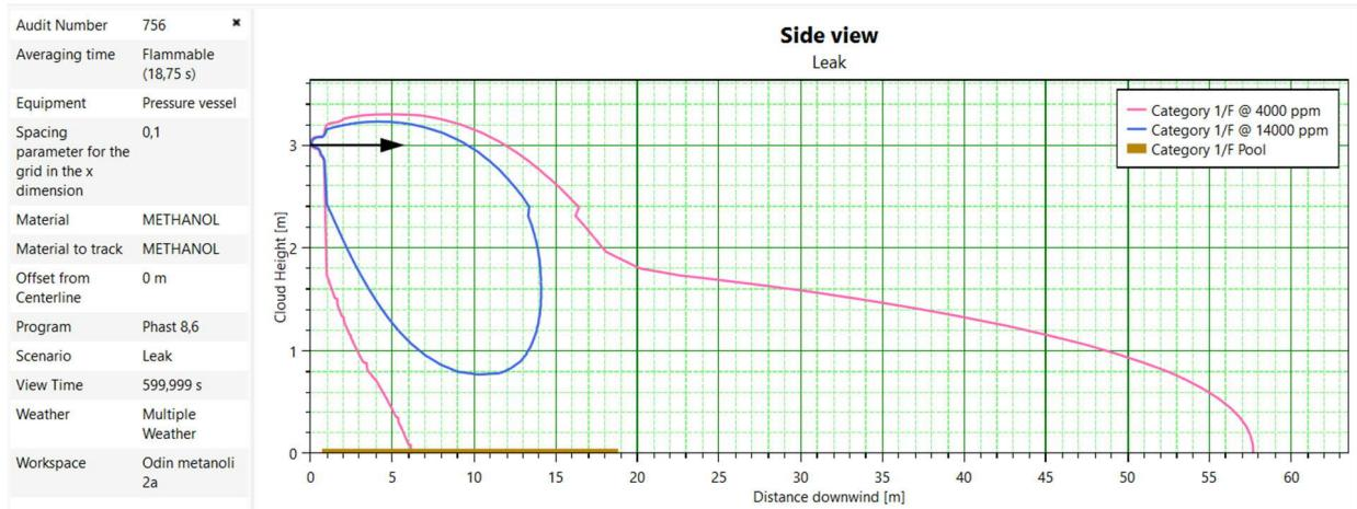
Kuva 6.4.1 Sivunäkymä 4000 ja 14000 ppm:n metanolihöyrypilvestä sääolosuhteessa 1/F. Täten korkeampi metanolipitoisuus (14 000 ppm = AEGL 3) yltää n. 15 metrin päähen vuotokohdasta.
