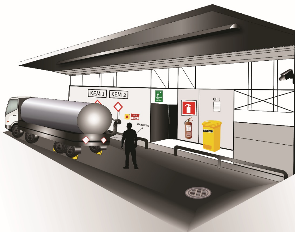
Kuva 6. Yleiskuva säiliöauton täyttö- ja tyhjennyspaikasta.
