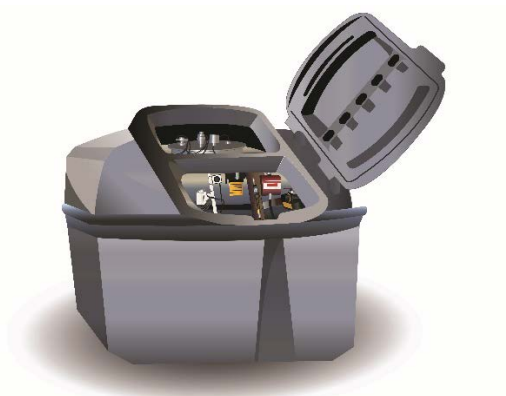
Suuntaa antava piirros avattavasta kaksivaipparakenteesta
