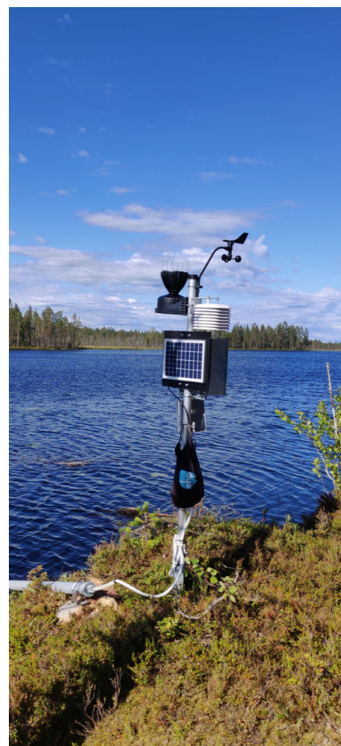
Mittausasema tekee havaintoja säästä ja pintaveden korkeudesta. Kuva: Mawson Oy.
