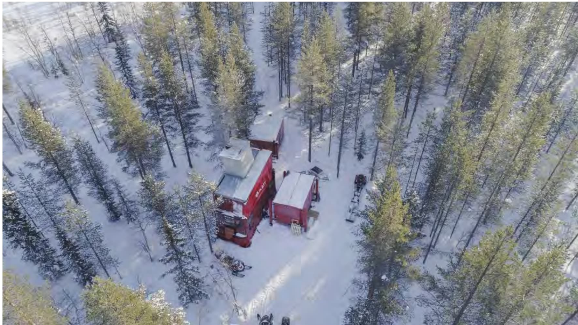
Kuva 3-3. Syväkairauskone DE 150 kairaamassa. Kairakoneen vieressä suljetun kierron kontti ja kontti, joka sisältää kairausputket. © AA Sakatti Mining Oy
