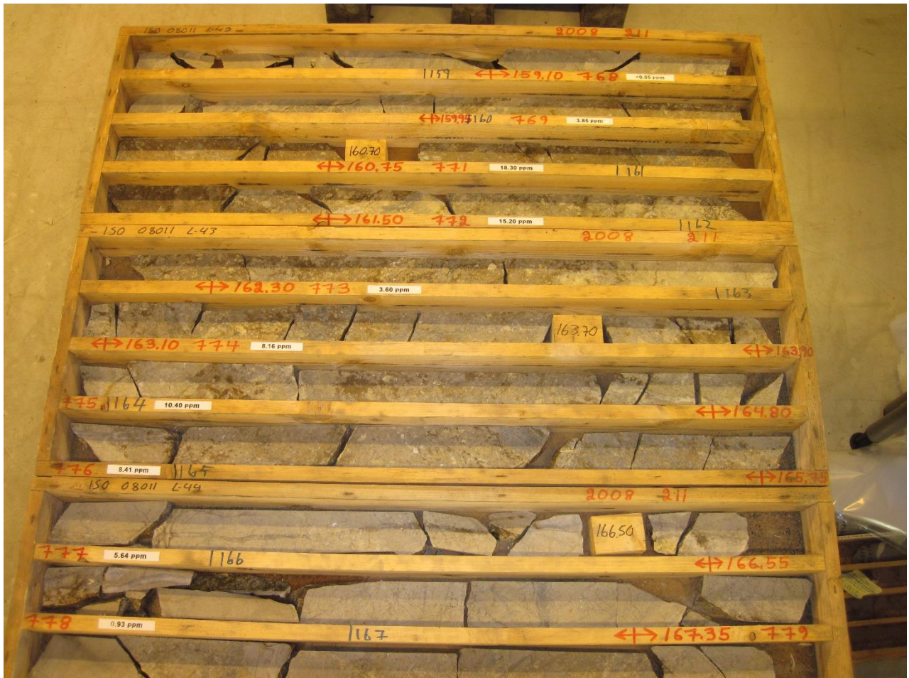
Kuva 4-10. Retu; Kvartsi-dolomiitti -juonibreksia, jossa runsaasti kiisuja (Po, Apy, Py); ISO08011 sijaitsee esiintymän SW-osissa (profiili 7, lävistys 159.35-167.35 m/28.24 ppm Au; 7.4 m/kairauspituus ja 5.18 m/ todellinen leveys); ks. ed. kuva.
