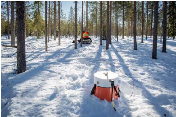
Kuva 4. Vastaanotin (Rx) silmukan keskustassa
