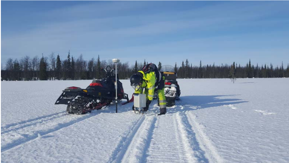
Kuva 8. Painovoima mittauskalusto, kaksi moottorikelkkaa, GPS-laite lumihangessa pystyssä sekä mittaja asettamassa gravimetria paikalleen.
