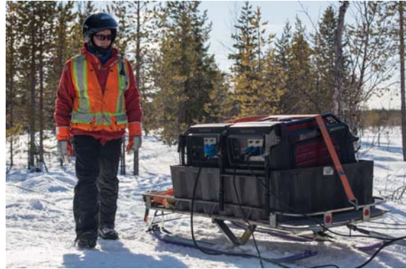
Kuva 3. Lähetintä (Tx) kuljetetaan mittauslinjalla moottorikelkalla ja reellä
