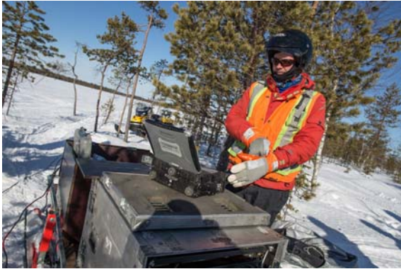
Kuva 2. Lähetintä (Tx) kuljetetaan mittauslinjalla moottorikelkalla ja reellä. Kaapelit näkyvät kuvan vasemmassa alakulmassa
