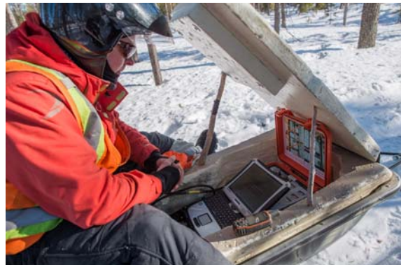
Kuva 5. Mittaaja käyttää vastaanotinta kaapeli-silmukan keskellä ja tallentaa kallioperästä tulevaa sähkömagneettista signaalia.
