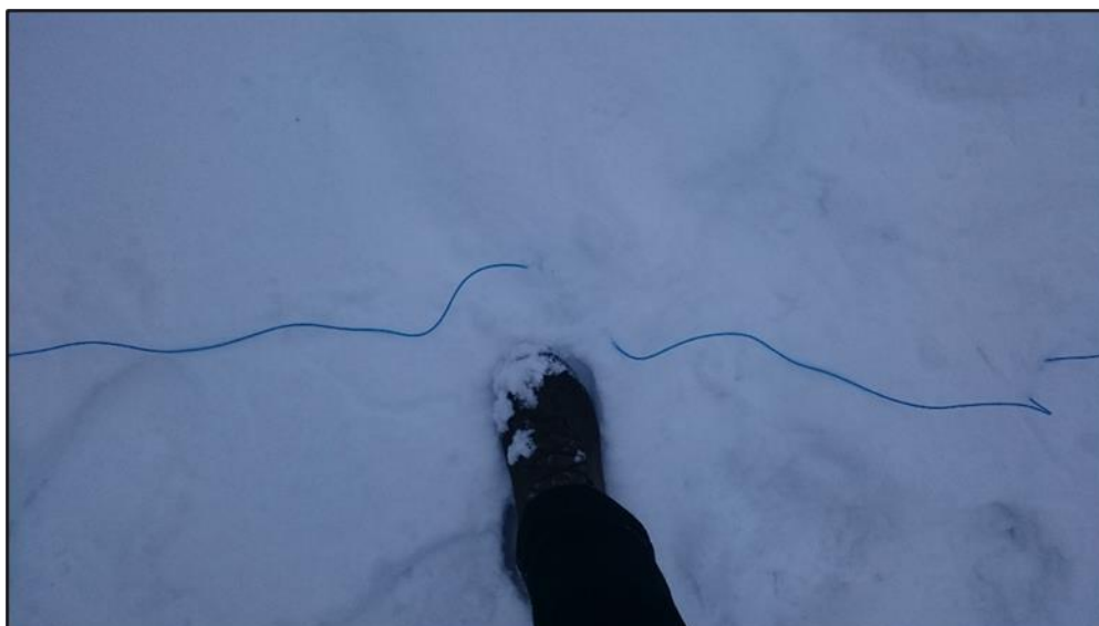
Kuva 6: Elektrodit yhdistetään toisiinsa maan pinnalla kulkevalla sähköjohdolla
