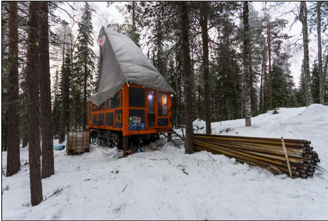
Kuva 11: Suuri syväkairauskairauslaitteisto puustoisessa tutkimuskohteessa.
