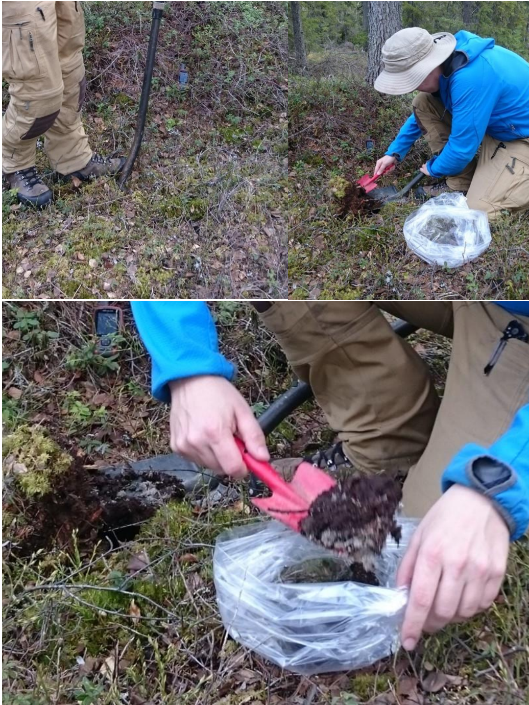
Kuvat 4: Käsintehtävä maaperänäytteenotto (Ah)
