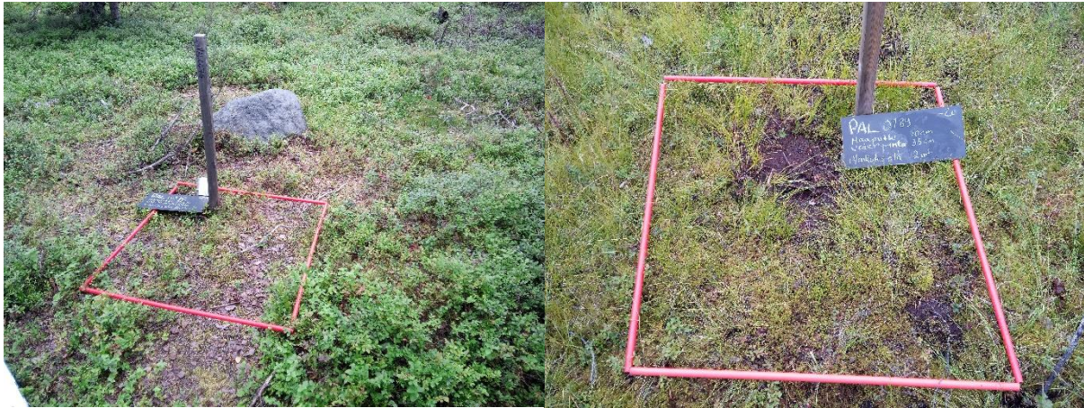
Kuvat 13: Yllä kuvat neljältä erilaiselta syväkairauspaikalta kasvukauden alussa. Syväkairaukset on toteutettu talvikaudella, eli kuvat otettu noin 3 kuukautta näytteenoton jälkeen. Punainen neliö on yhden neliömetrin suuruinen.
