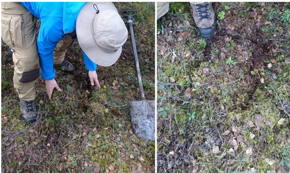
Kuvat 3: Käsintehävä maaperänäytteenotto (moreeninäyte)
