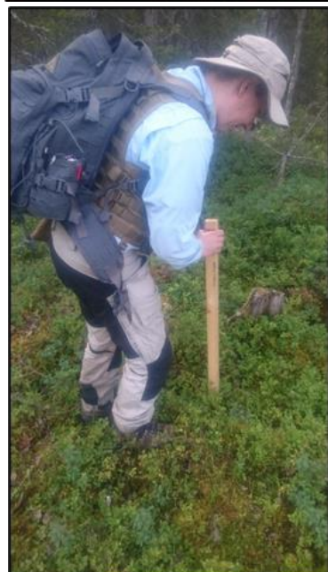
Kuvat 7: Kuvasarjassa on esitetty kesäaikana toteutettu koneellinen pohjamoreeninäytteenottoaika (ns. BOT, Bottom of till) välittömästi näytteenoton päätyttyä. Jälkiä ei ole havaittavissa. Talvella toteutettuja BOT-paikkoja on käytännössä mahdotonta havaita sulan maan aikana.
