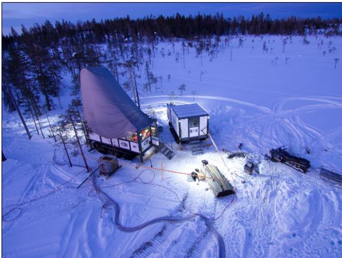
Kuva 10: Suuri syväkairauslaitteisto ja soijankeräysjärjestelmä tutkimuskohteella
