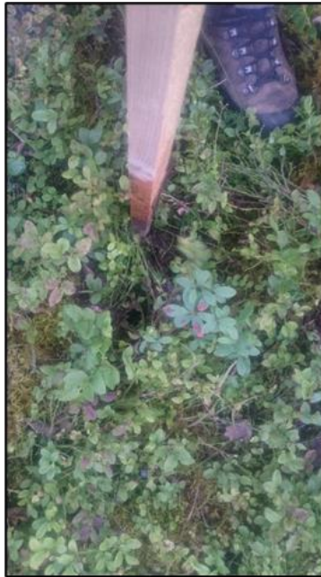
Kuvat 7: Kuvasarjassa on esitetty kesäaikana toteutettu koneellinen pohjamoreeninäytteenottoaika (ns. BOT, Bottom of till) välittömästi näytteenoton päätyttyä. Jälkiä ei ole havaittavissa. Talvella toteutettuja BOT-paikkoja on käytännössä mahdotonta havaita sulan maan aikana.
