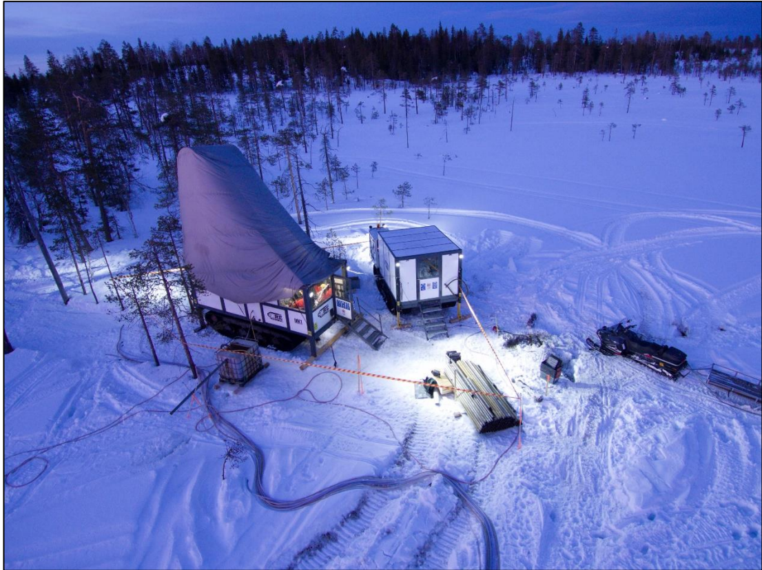
Kuva 25: Timanttisyväkairauslaitteisto ja vedenpuhdistuskontti (Huom! Kuva Natura-alueen ulkopuolelta)
