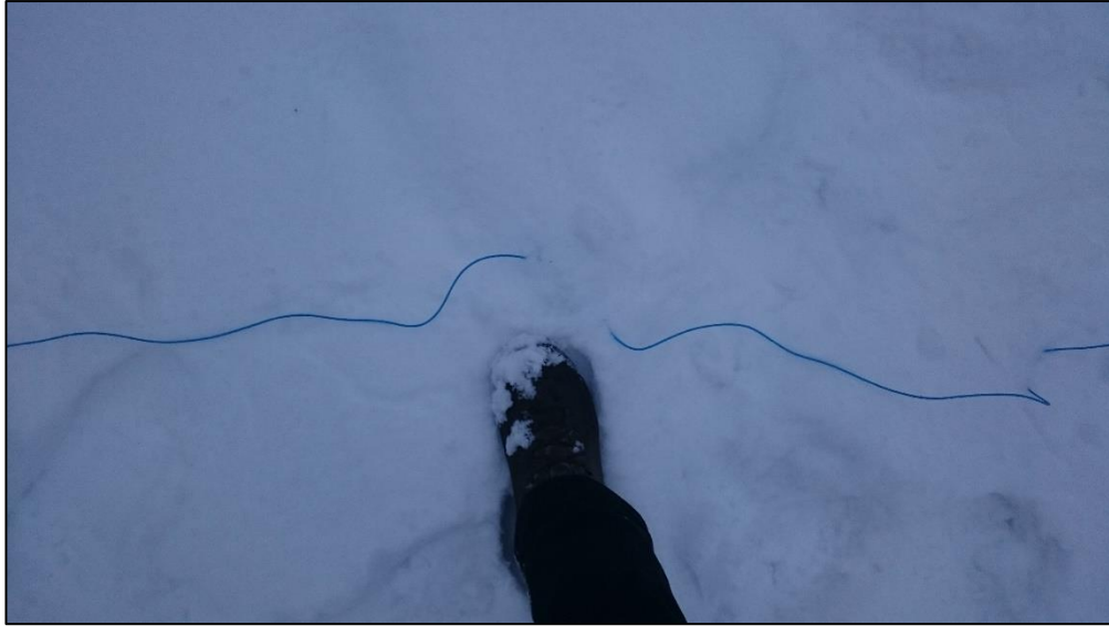
Kuva 17: Elektrodit yhdistetään toisiinsa maan pinnalla kulkevalla sähköjohdolla
