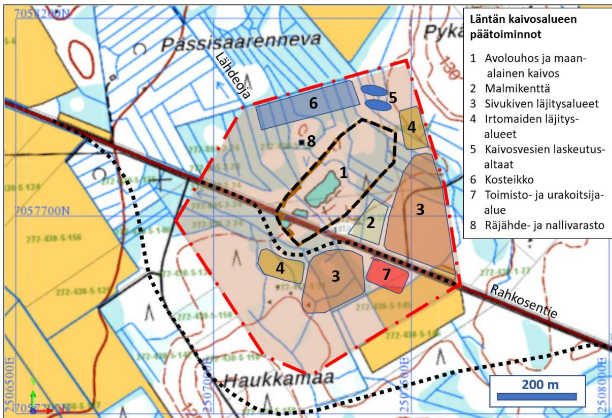
Kuva 2. Läntän kaivosalueelle sijoittuvat päätoiminnot. Kaivosaluerajaus on esitetty punaisella katkoviivalla ja tielinjausten muutokset mustalla katkoviivalla.
