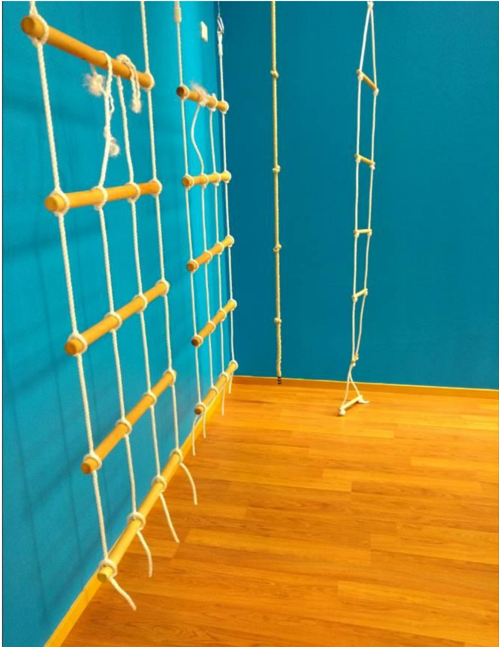
Kuva 3. Kuvassa Irrallaan olevat roikkuvat narut aiheuttavat kuristumisvaaraa lapsille. Narujen tulee olla sellaisia tai ne tulee kiinnittää siten (esim. molemmista päistä), että niistä ei saa muodostettua vaarallista lenkkiä.
