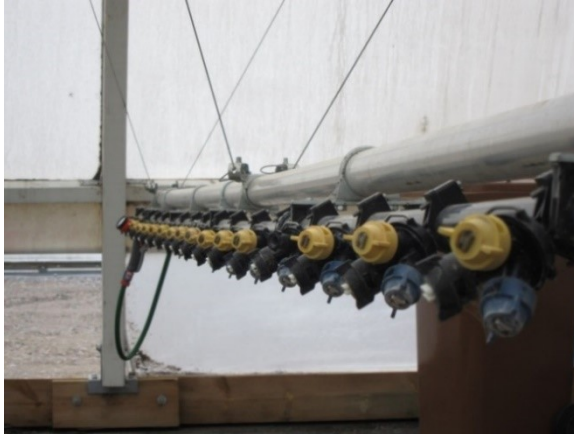
KUVA 15. Suuttimien suoruuden näkee helposti sivusta katsottuna.
