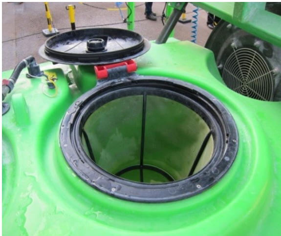
KUVA 3. Täyttöaukon siivilä ja tiivis kansi.
