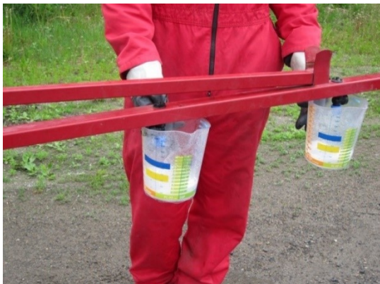
KUVA 17. Yksinkertainen tapa mitata paljonko minuutin aikana nestettä virtaa. (Huomaa mittakannujen tarkkuus).
