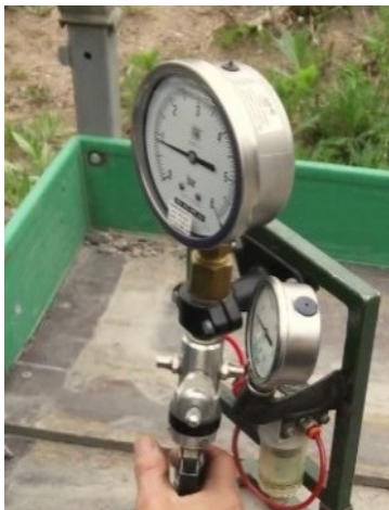
KUVA 11. Painemittarin testaus mittapenkissä. Peruspuomiruiskun painemittarit voidaan tarkastaa esimerkiksi nostaen painetta yhdestä viiteen baariin 1,0 baarin välein ja sen jälkeen laskien painetta viidestä yhteen baariin 1,0 baarin välein.
