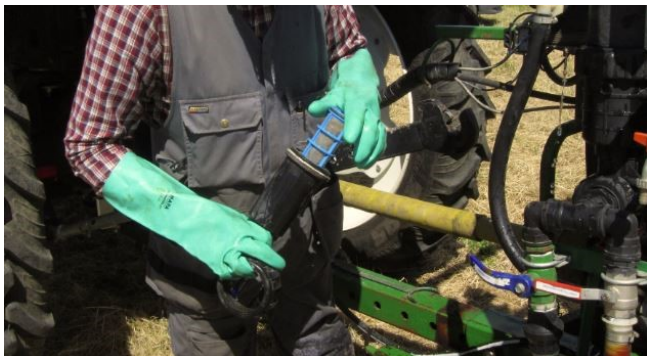
KUVA 6. Suodattimien on oltava ehjiä ja puhtaita.
