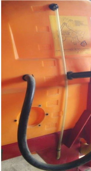
KUVA 4. Yksinkertainen ratkaisu, josta kuljettaja näkee säiliössä olevan nestemäärän.
