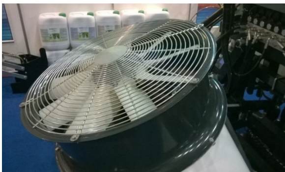
KUVA 7. Puhaltimessa pitää olla suojaritilä.
