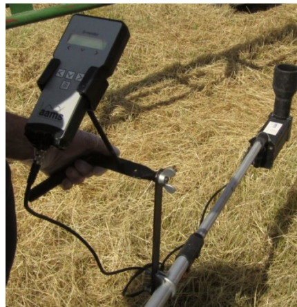
KUVA 18. Testausta helpottava ja nopeuttava sähköinen suuttimen virtausmittari.
