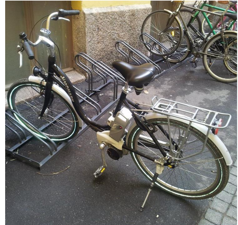
Kuva: teollisuusakkuksi luokiteltavaa litiumioniakkua hyödyntävä sähköpolkupyörä
