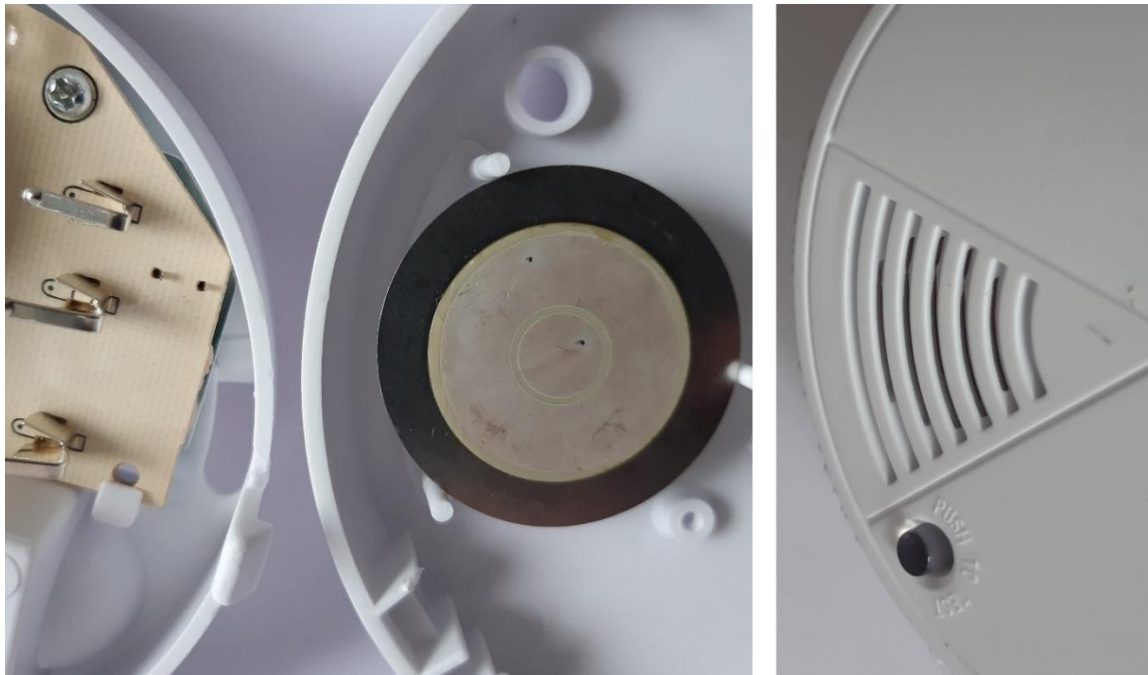
Kuva 3. 2010-luvulla valmistetun palovaroittimen pietsoelementti ja kuva elementin kohdalta varoittimen ulkopinnalta
