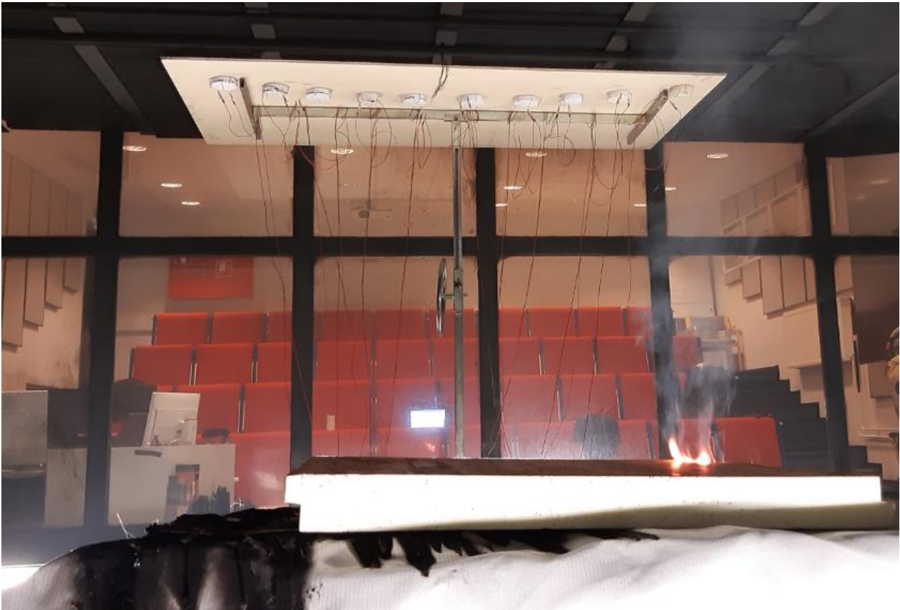
Kuva 8. Polyuretaanipalo levyn sytytyksen jälkeen.
