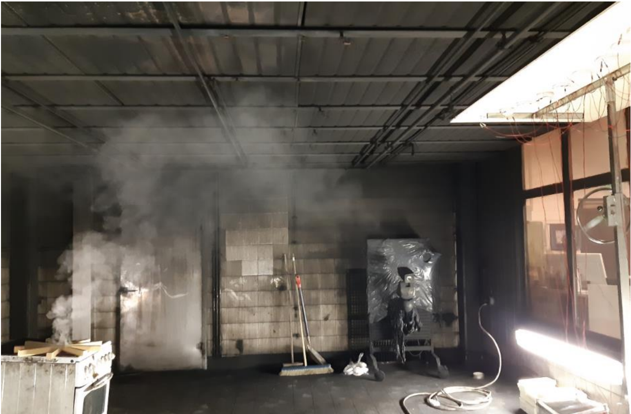
Kuva 7. Kytevä puupalo. Kytevät puukalikat kuvan vasemmassa reunassa ja palovaroittimet kattoon kiinnitettynä kuvan oikeassa yläreunassa.
