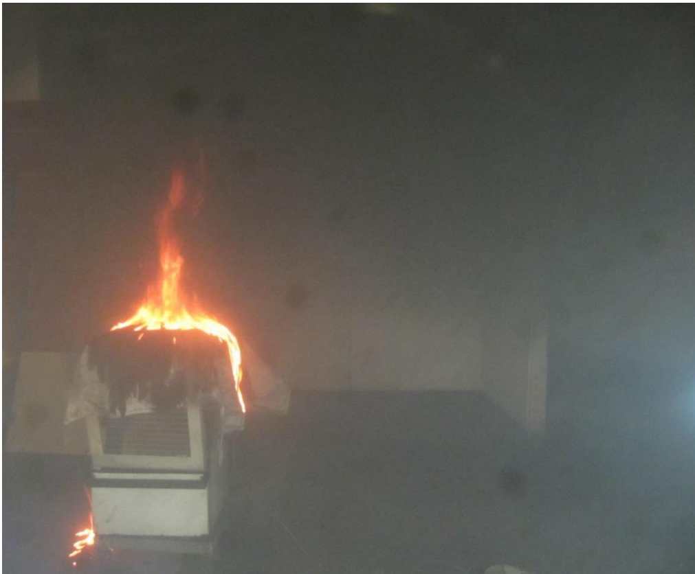
Kuva 9. Paloteatterin palotila polyuretaanipalon aikana
