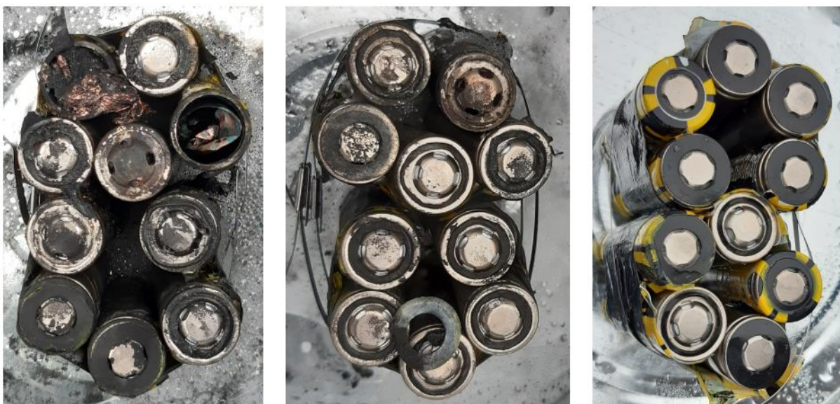
Kuva 7. Kennot Presto LB6 -sammuttimella sammuttamisen jälkeen.
