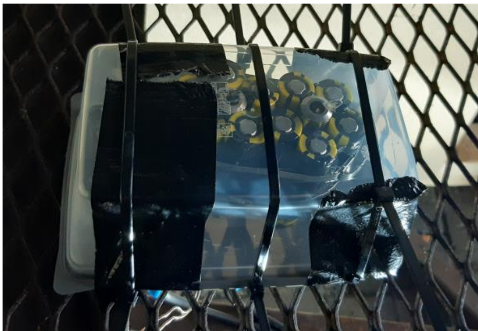
Kuva 3. Ritilään kiinnitetty valmis akkupaketti ennen testausta.
