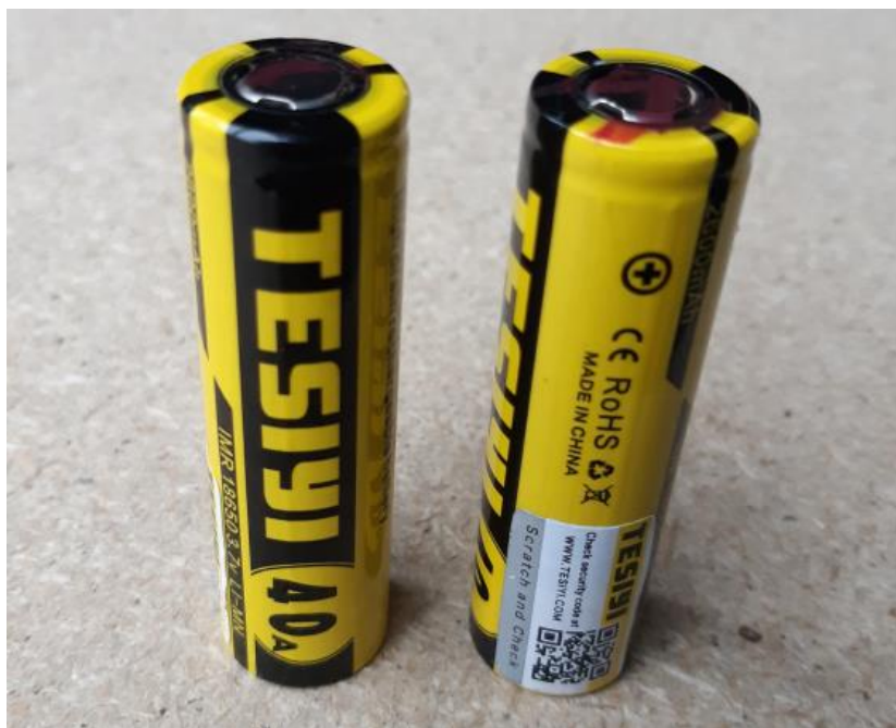
Kuva 1. Testeissä käytettyjä 18650 -kennoja.
