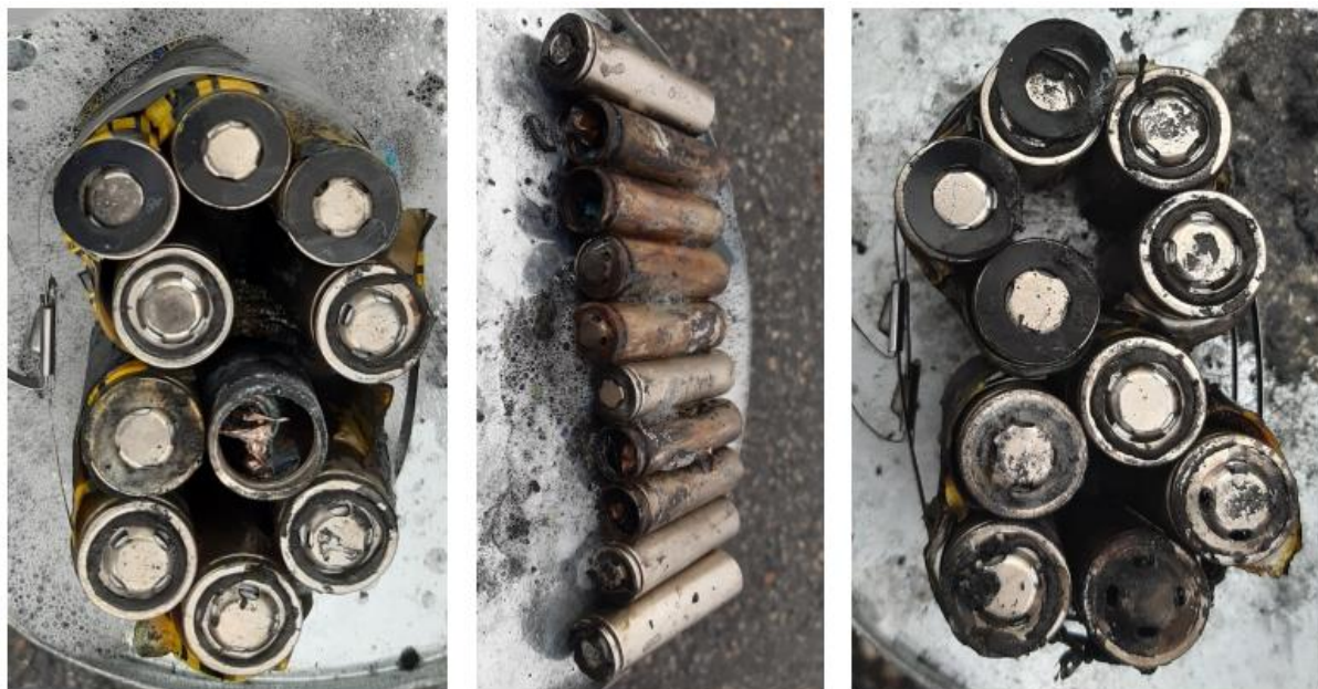
Kuva 10. Kennot Gloria -vaahtosammuttimella sammuttamisen jälkeen.
