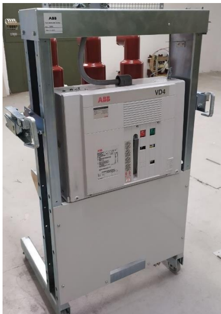
Kuvat 9. ja 10. Katkaisijavaunu ja varaus mittauskennolle kiskolla 1B
