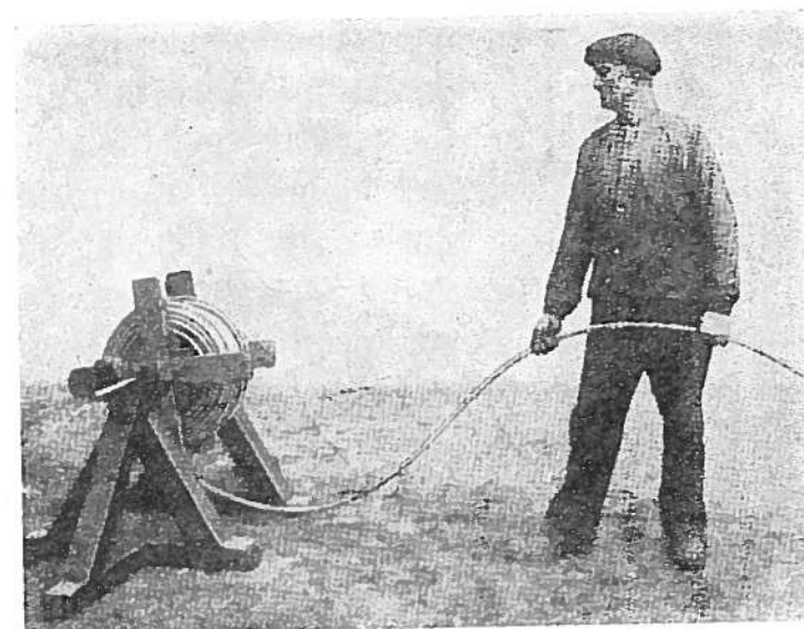
Kuva 34. Oikea köyden vapauttamistapa jalustalliselta ristikkokelalta.
