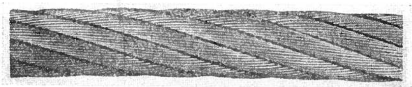
Kuva 13. Ristiinpunottu oikeakierteinen teräslankaköysi.
