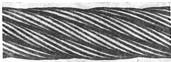
Kuva 15. Uusi yhtäällepunottu teräslankaköysi.
