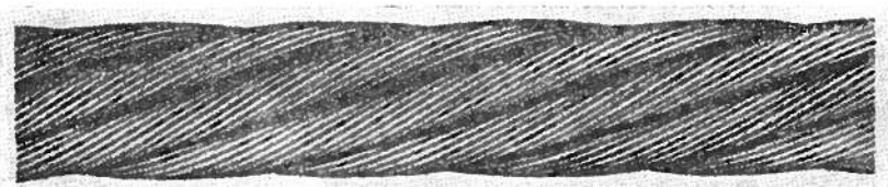
Kuva 11. Yhtäällepunottu vasenkierteinen teräslankaköysi.
