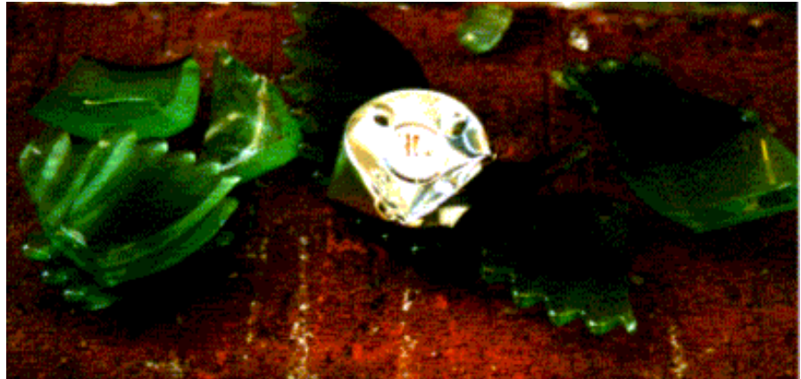
Kuva 10. Lämpökynntilän allaspalon aikana syntyneiden jännitysten pirstaleiksi särkemä lasinen lyhty. On huomattavaa, että osaset ovat lentäneet paikaltaan jättäen lämpökynntilän alustan päälle, jolloin palava-aineinen alusta olisi voinut syttyä tuleen.
