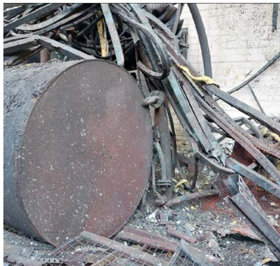
Kuvat 7., 8.,9. ja 10. Tukesin ottamia valokuvia paisuntaöljylinjasta ja paisuntaöljysäiliöstä
