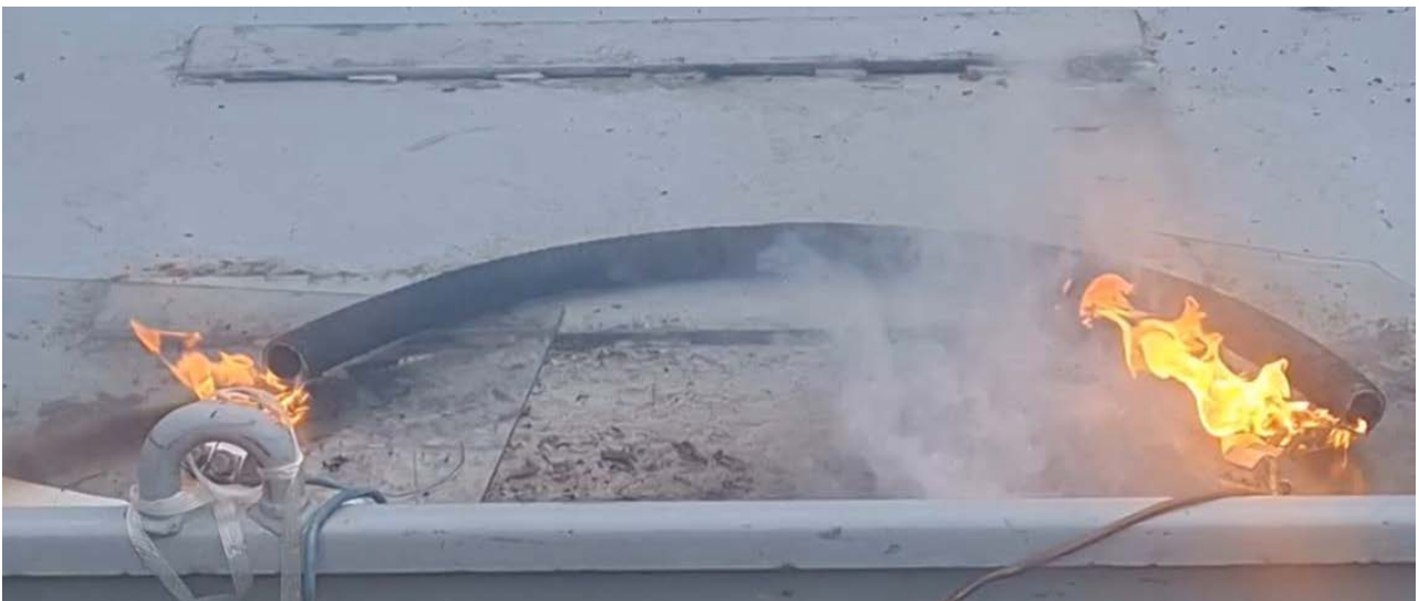
Kuva 13. Testissä tuleen syttynyt öljyletku
