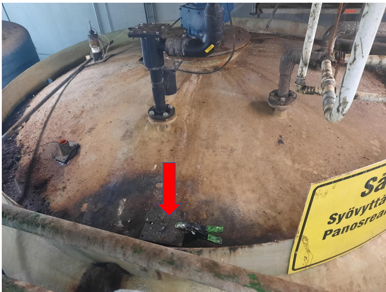
Kuva 3. Reaktorisäiliön S10 yläosa. Etualalla nuolella merkittynä näytteenottoyhde, jonka kautta kaasua pääsi vapautumaan hallitilaan. (Kuva: Tukes)
