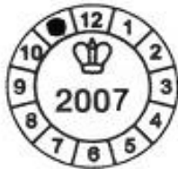
Kuva 5.10 Tehdyn vakauksen ilmaiseva merkki. Tässä esimerkissä vakaus on tehty marraskuussa 2007.
