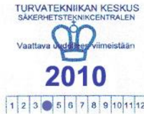
Kuva 5.12 Seuraavan vakausajankohdan ilmaiseva merkintä. Tässä esimerkissä seuraava vakaus on tehtävä viimeistään huhtikuussa 2010.
