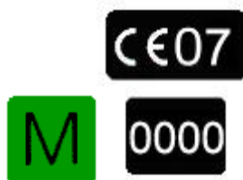
Kuva 5.6 Ei-automaattisen vaa'an vaatimustenmukaisuuden ilmaiseva merkkijhdistelmä Tässä esimerkissä vaa'an määräaikaisvakuus on tehtävä viimeistään vuoden 2010 lopussa
