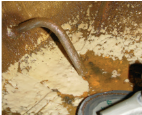
Tyypillinen ilmasäiliön pohja. Säiliön sisälle jäävä kosteus syövyttää tyhjennussyhteen ympäristöä.
