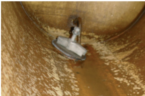
Tyypillinen ilmasäiliön pohja. Säiliön sisälle jäävä kosteus syövyttää tyhjennussyhteen ympäristöä.
