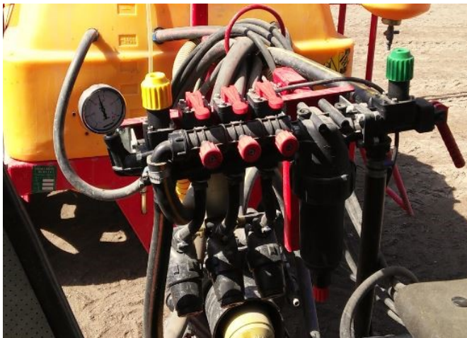
BILD 19. Läckagetest med stängda sektioner. Vätska får inte läcka från något ställe under testningen.
