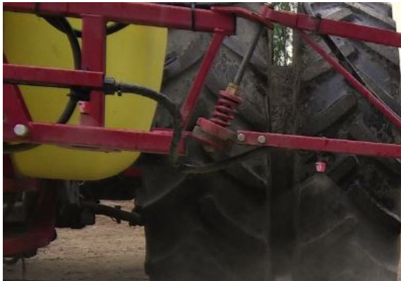
BILD 12. Fjädring som dämpar bomrörelsen.
