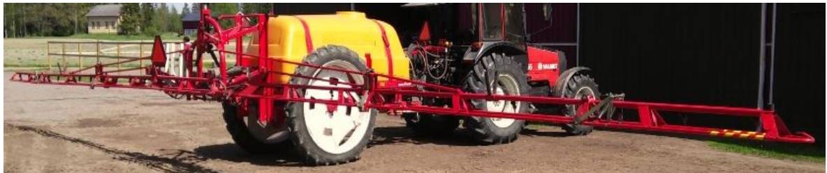
BILD 16. Odeformerad och stabil bomanordning.
