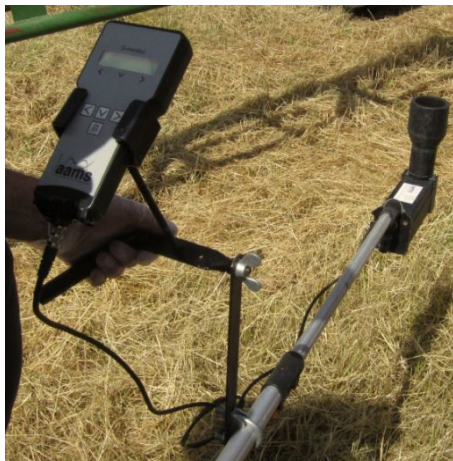
BILD 22. Flödesmätare för munstycken för mätning av volymflödet, vilken underlättar och påskyndar testningen.
