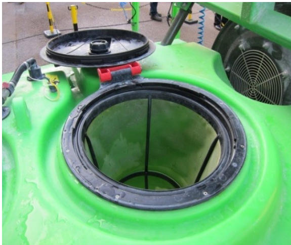
BILD 3. Sil för påfyllningsöppningen och ett tätt lock.
