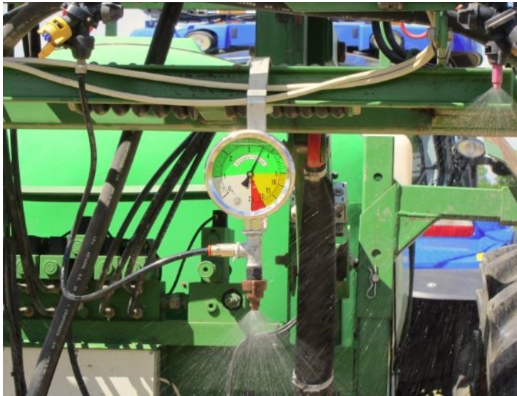
BILD 20. Mätning av tryckfördelningen.
