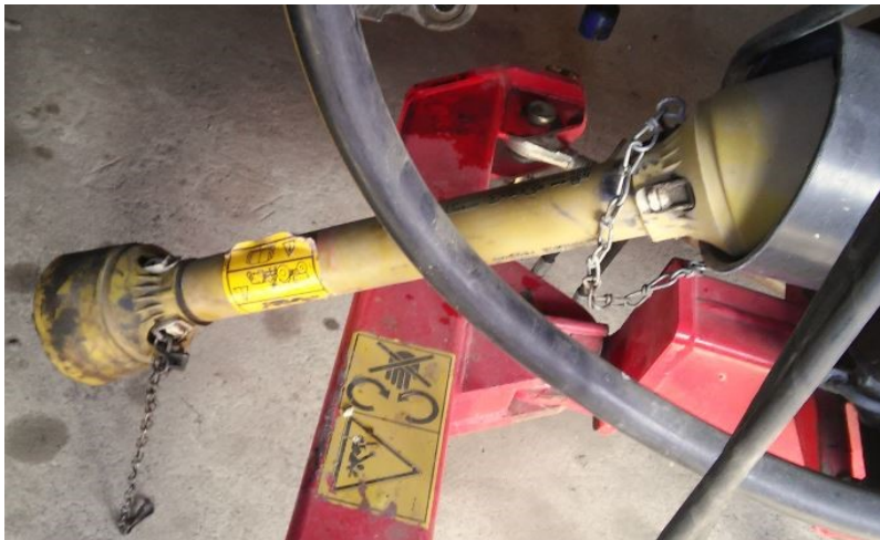
BILD 2. En kraftöverföringsaxel med ett helt skydd, som inte roterar med axeln
