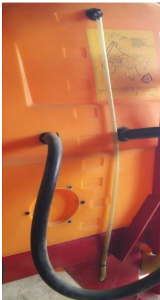
BILD 4. En enkel lösning där föraren ser den mängd vätska som finns i tanken.
