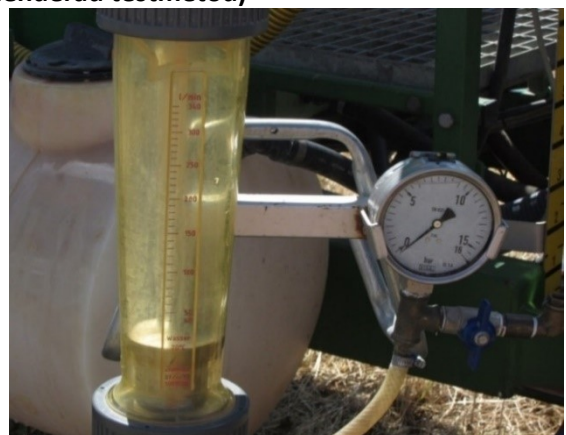
BILD 14. Pumpens kapacitet och eventuellt luftläckage syns på en flödesmätare. Det rekommenderas att man i samband med mätning av
