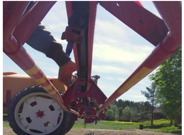
BILD 18. Från sidan ser man enkelt om munstyckena är raka. Det viktigaste är förstås att sprutduschen inte träffar sprutdelarna och att testningen av spridningsjämnheten kan godkännas.
