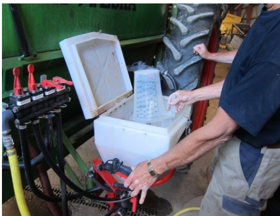
BILD 11. Sköljning av ett mätkärl med en tvättanordning för kemikalieförpackningar.
