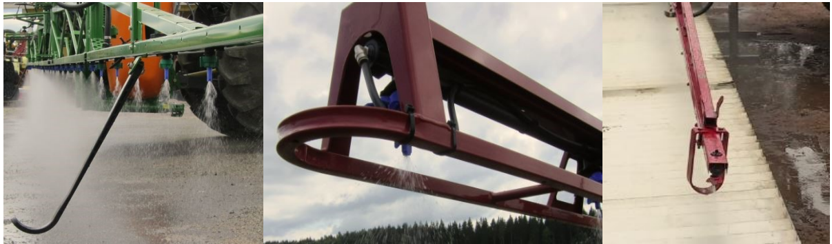
BILD 15. Det finns flera olika metoder för att hindra att munstyckena träffar marken.
