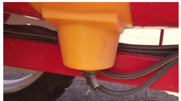
BILD 5. Tömningskran på vilken det är möjligt att montera en förlängningsslang.
