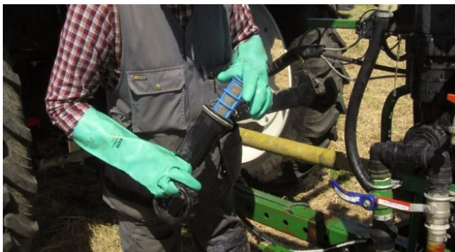
BILD 6. Filtren ska vara hela och rena.
