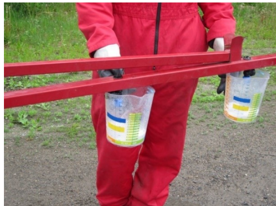
BILD 23. Ett enkelt sätt att mäta hur mycket vätska som flyter under en minut. Observera att mätkannorna på bilden inte är tillräckligt noggranna.
