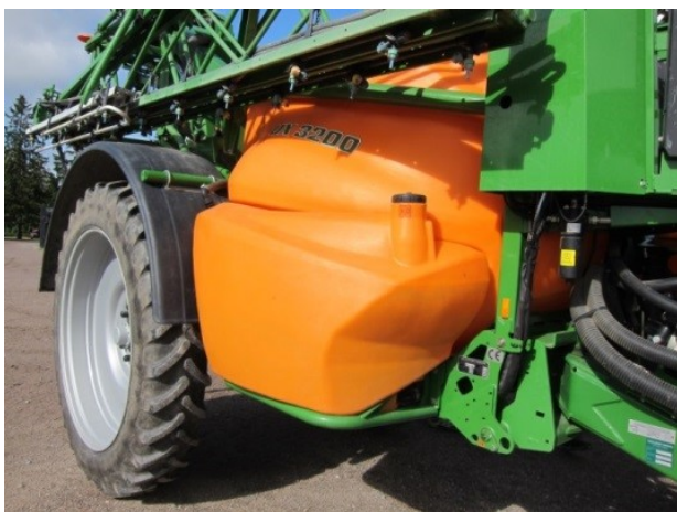
BILD 10. En sköljvattentank är en del av tvättsystemet. Växtskyddsmedel får aldrig sättas i sköljvattentanken.
