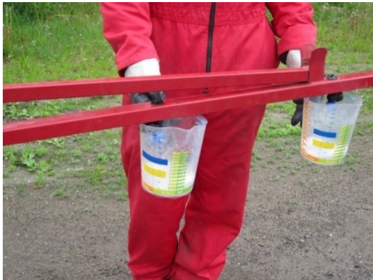
BILD 17. Ett enkelt sätt att mäta hur mycket vätska som flyter under en minut. Observera att mätkannorna på bilden inte är tillräckligt noggranna).
