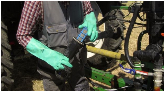
BILD 6. Filtren ska vara hela och rena.
