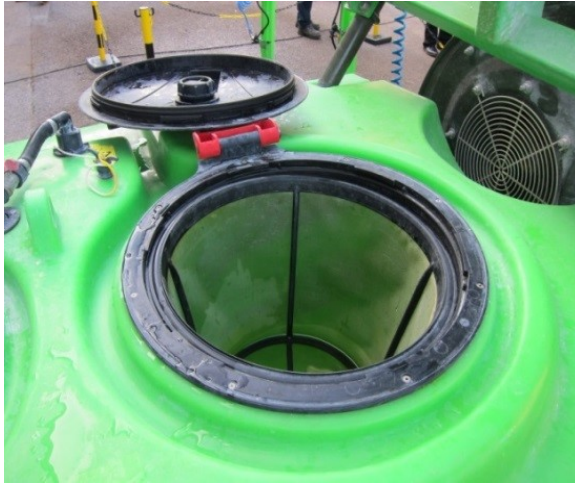
BILD 3. Sil för påfyllningsöppningen och ett tätt lock.
