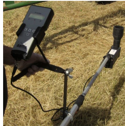
BILD 18. Flödesmätare för munstycken för mätning av volymflödet, vilken underlättar och påskyndar testningen.
