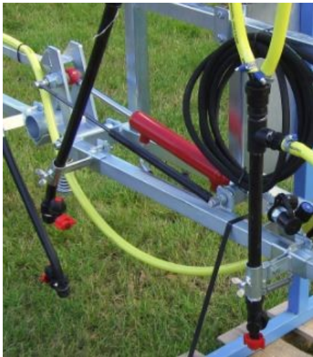
BILD 10. Stabilisatorerna ska vara i skick.
