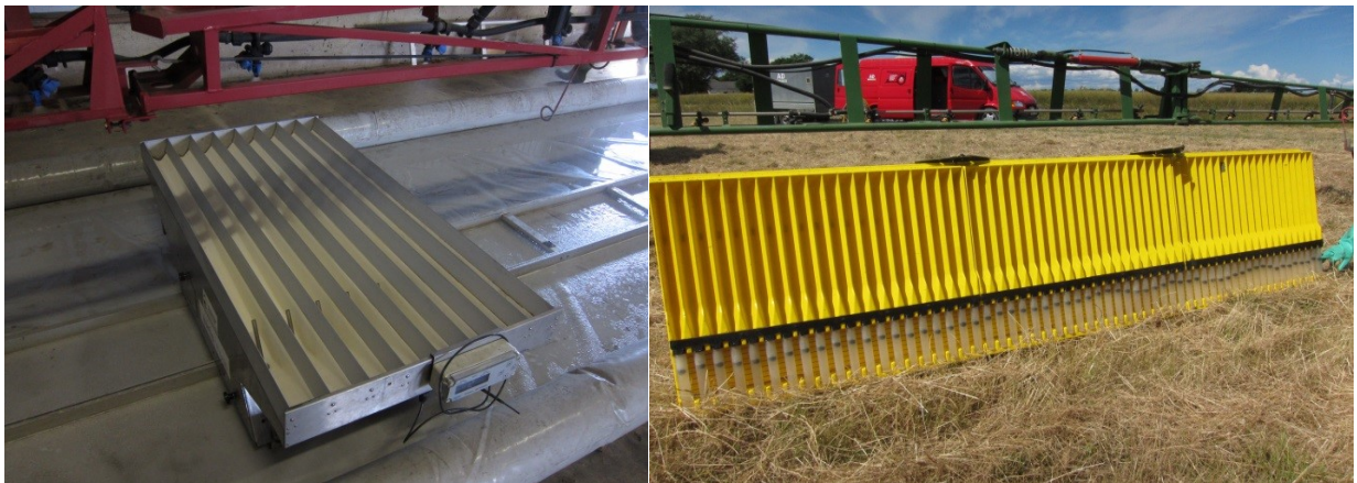
BILD 1. Scanner-mätanordning till vänster och ett mer traditionellt mätbord till höger.
