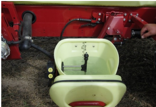
BILD 9. Anordningen för påfyllning av kemikalier ska finnas på en lättåtkomlig plats, så att det inte finns fara för att det stänker på en arbetstagare då han eller hon fyller tanken.
