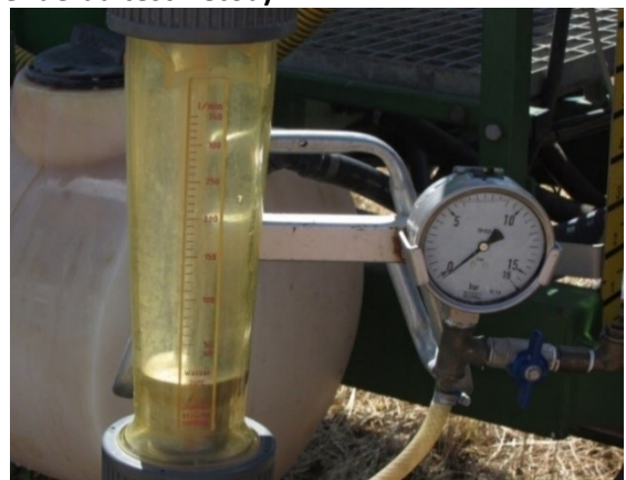
BILD 12. Pumpens kapacitet och eventuellt luftläckage syns på en flödesmätare.
