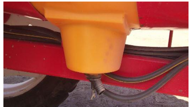
KUVA 5. Tyhjennyshana, johon on mahdollisuus asentaa vielä jatkoletku
