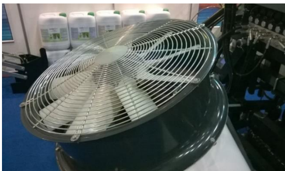
KUVA 7. Puhaltimessa pitää olla suojaritilä.
