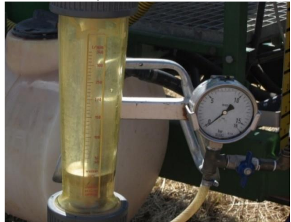
KUVA 12. Pumpun tuoton ja mahdollisen ilmuuodon näkee virtausmittarilla.
