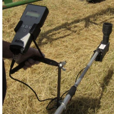
KUVA 18. Testausta helpottava ja nopeuttava sähköinen suuttimen virtausmittari.
