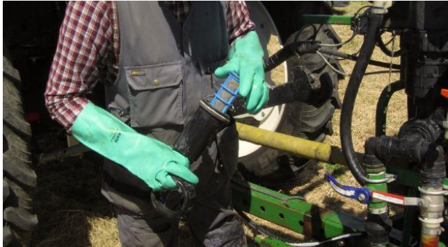
KUVA 6. Suodattimien on oltava ehjiä ja puhtaita.
