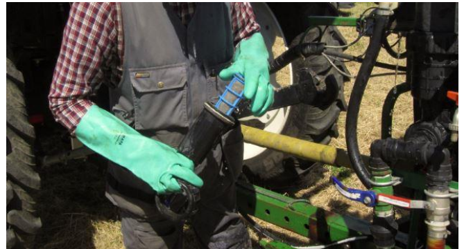
KUVA 6. Suodattimien on oltava ehjiä ja puhtaita.
