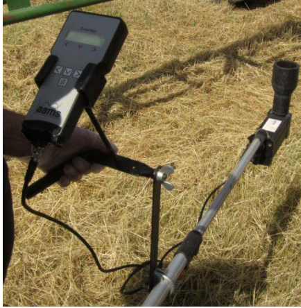
KUVA 23. Testausta helpottava ja nopeuttava suuttimen virtausmittari tilavuusvirran mittaukseen.
