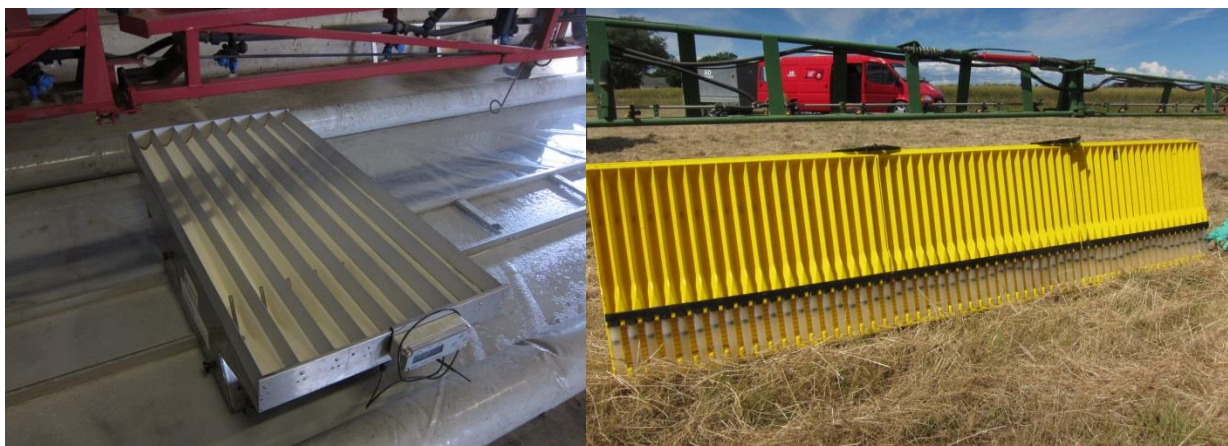
KUVA 1. Vasemmalla Scanner -mittalaite ja oikealla perinteisempi mittauspöytä.
