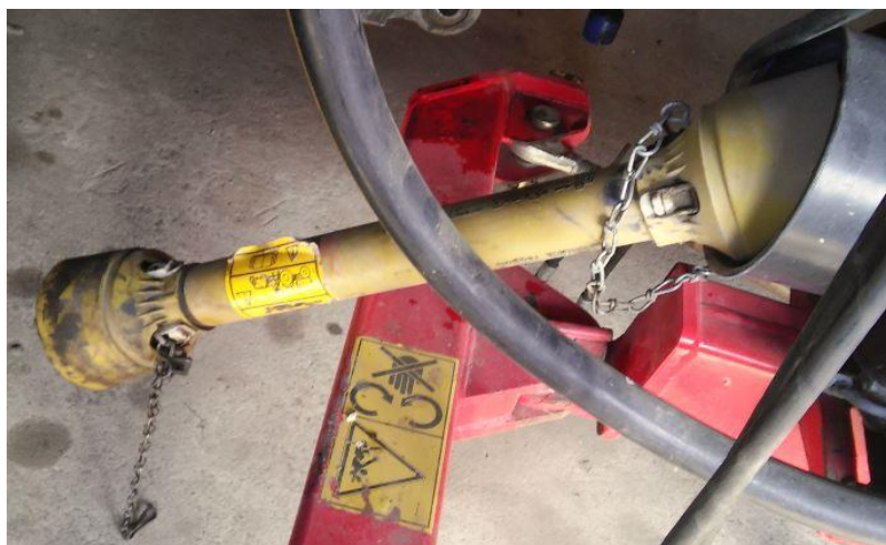
KUVA 2. Ehjä voimansiirtoakselin suojus, joka ei pyöri akselin mukana.
