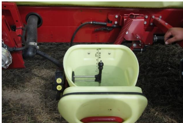
KUVA 9. Kemikaalien täyttölaitteen olisi hyvä olla helppossa paikassa, jolloin työntekijällä ei ole vaaraa saada roiskeita päälleen täyttäessä säiliötä
