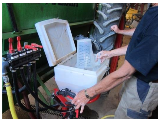
KUVA 11. Mitta-astian huuhtelu kemikaalipakkausten pesulaitteella.
