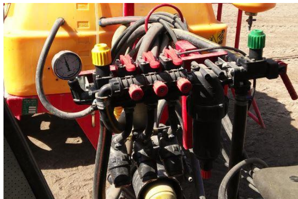
KUVA 19. Vuototesti jaokkeet suljettuina. Mistään ei saa vuotaa nestettä testin aikana.
