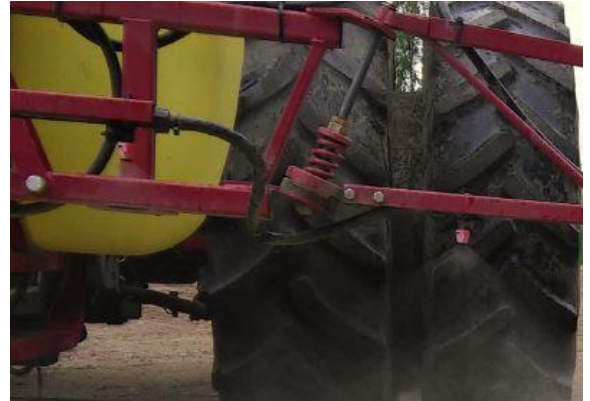
KUVA 12. Puomin liikettä vaimentava jousi.
