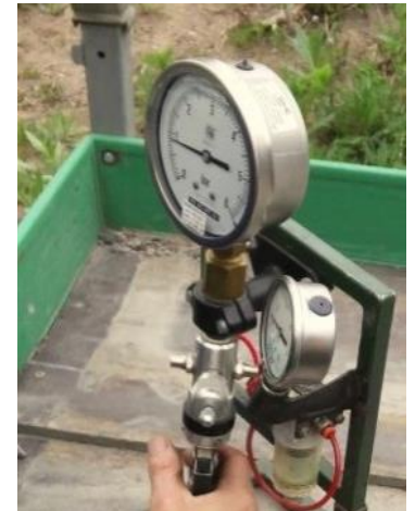
KUVA 13. Painemittarin testaus mittapenkissä. Peruspuomiruiskun painemittarit voidaan tarkastaa esimerkiksi nostamalla painetta yhdestä viiteen baariin 1,0 baarin välein ja sen jälkeen laskien painetta viidestä yhteen baariin 1,0 baarin välein.
