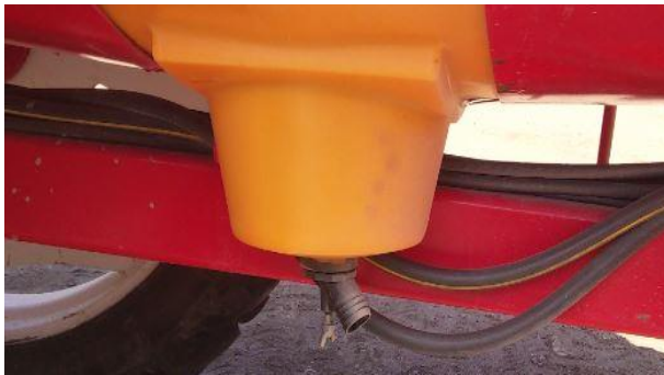
KUVA 5. Tyhjennyshana, johon on mahdollisuus asentaa vielä jatkoletku.
