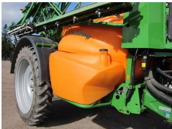
KUVA 10. Huuhteluvesisäiliö on osa pesujärjestelmää. Siihen ei saa koskaan laittaa kasvinsuojeluaineita.
