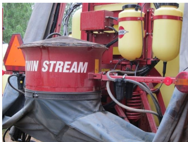
KUVA 7. Puhaltimessa pitää olla suojaritilä.
