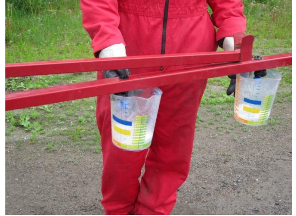
KUVA 24. Yksinkertainen tapa mitata paljonko minuutin aikana nestettä virtaa. Huomaa kuvassa mittakannujen riittämätön tarkkuus.
