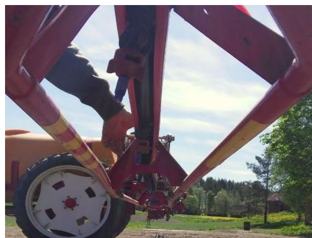
KUVA 18. Suuttimien suoruuden näkee helposti sivusta katsottuna. Tärkeintä tietysti on, että suuttimien viuhkat eivät osu ruiskun osiin ja levitystasaisuudesta on hyväksyttävä.
