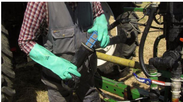
KUVA 5. Suodattimien on oltava ehjiä ja puhtaita.
