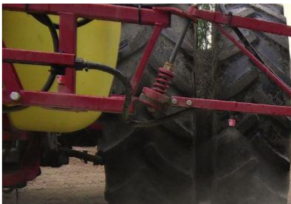
KUVA 12. Puomin liikettä vaimentava jousi.
