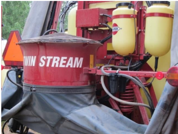
KUVA 6. Puhaltimessa pitää olla suojaritilä.
