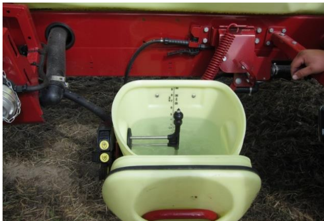
KUVA 89 Kemikaalien täyttölaitteen olisi hyvä olla helppossa paikassa, jolloin työntekijällä ei ole vaaraa saada roiskeita päälleen täyttäessään säiliötä.
