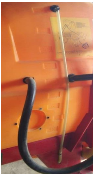
KUVA 3. Yksinkertainen ratkaisu, josta kuljettaja näkee säiliössä olevan nestemäärän.
