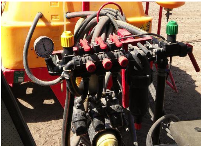
KUVA 19. Vuototesti jaokkeet suljettuina. Mistään ei saa vuotaa nestettä testin aikana.
