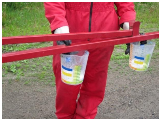
KUVA 23. Yksinkertainen tapa mitata paljonko minuutin aikana nestettä virtaa. Huomaa kuvassa mittakannujen riittämätön tarkkuus.
