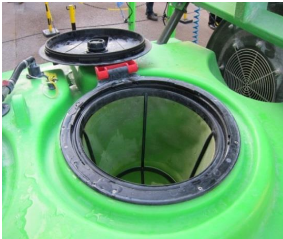
KUVA 2. Täyttöaukon siivilä ja tiivis kansi.
