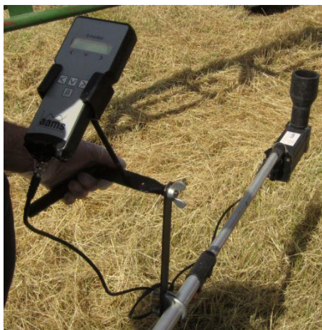
KUVA 22. Testausta helpottava ja nopeuttava suuttimen virtausmittari tilavuusvirran mittaukseen.
