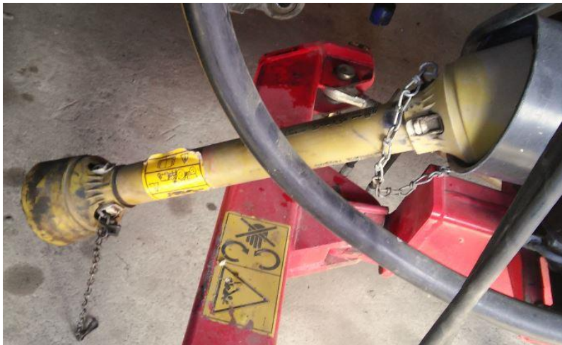
KUVA 1. Ehjä voimansiirtoakselin suojus, joka ei pyöri akselin mukana.
