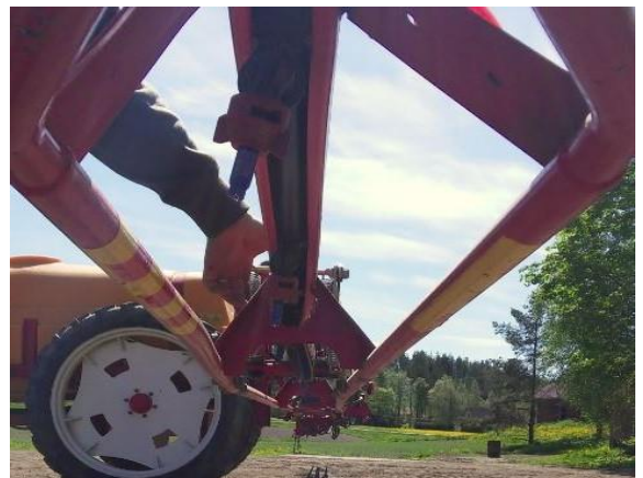
KUVA 18. Suuttimien suoruuden näkee helposti sivusta katsottuna. Tärkeintä tietysti on, että suuttimien viuhkat eivät osu ruiskun osiin ja levitystasaisuudesta on hyväksyttävä.
