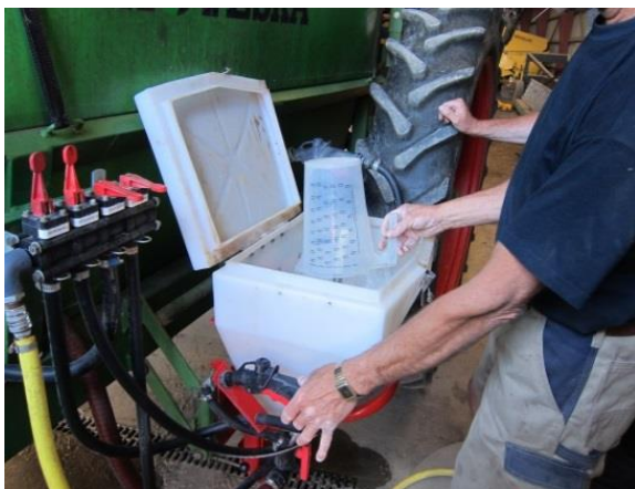
KUVA 11. Mitta-astian huuhtelu kemikaalipakkausten pesulaitteella.
