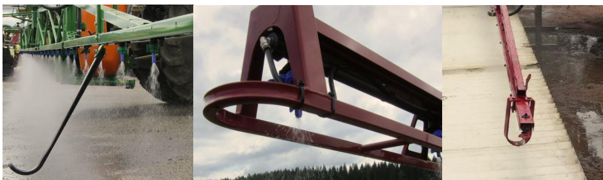
KUVA 15. Suuttimien maahan osumisen estäviä suoja on monia erilaisia.
