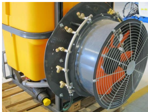
KUVA 6. Puhallin hyvin suojattuna.
