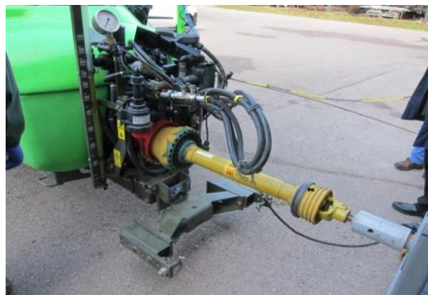
KUVA 1. Ehjä voimansiirtoakselin suojus, joka ei pyöri akselin mukana.
