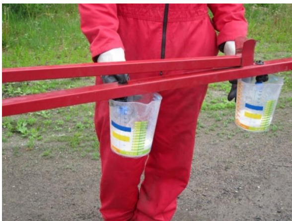
KUVA 16. Yksinkertainen tapa mitata paljonko minuutin aikana nestettä virtaa. Huomaa kuvassa mittakannujen riittämätön tarkkuus
