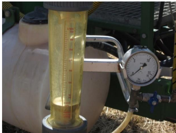
KUVA 12. Pumpun tuoton ja mahdollisen ilma- vuodon näkee virtausmittarilla. Tilavuusvirran mittauksen yhteydessä on suositeltavaa mitata myös ohivirtaus ruiskutuksen ollessa kytkettynä puomin kaikkiin jaokkeisiin.
