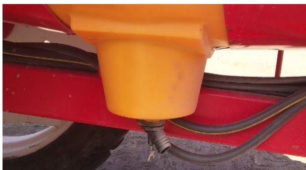
KUVA 4. Tyhjennyshana, johon on mahdollisuus asentaa vielä jatkoletku.
