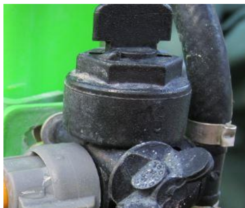
KUVA 19. Tippumisenestoventtiili on ihan suuttimen kyljessä.
