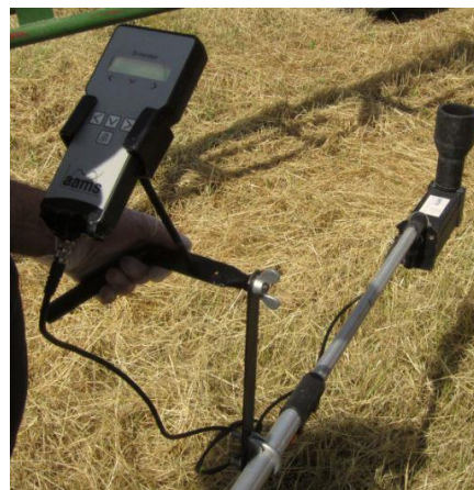
KUVA 17. Testausta helpottava ja nopeuttava suuttimen virtausmittari tilavuusvirran mittaukseen.
