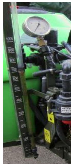
KUVA 3. Yksinkertainen ratkaisu, josta kuljettaja näkee säiliössä olevan nestemäärän.
