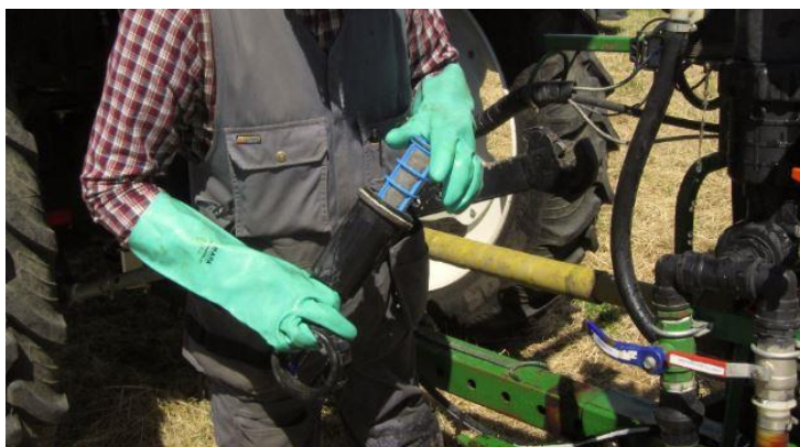
KUVA 5. Suodattimien on oltava ehjiä ja puhtaita.
