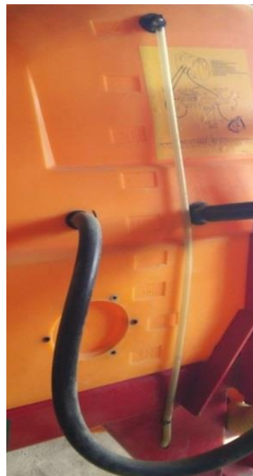
KUVA 4. Yksinkertainen ratkaisu, josta kuljettaja näkee säiliössä olevan nestemäärän.
