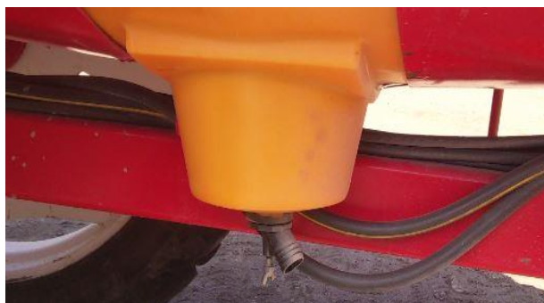
KUVA 5. Tyhjennyshana, johon on mahdollisuus asentaa vielä jatkoletku.
