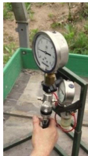
KUVA 11. Painemittarin testaus mittapenkissä. Peruspuomiruiskun painemittarit voidaan tarkastaa esimerkiksi nostaen painetta yhdestä viiteen baariin 1,0 baarin välein ja sen jälkeen laskien painetta viidestä yhteen baariin 1,0 baarin välein.
