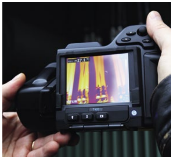
Lämpökuvauksella on mahdollista havaita palovaarallisia vikoja sähköasennuksissa
