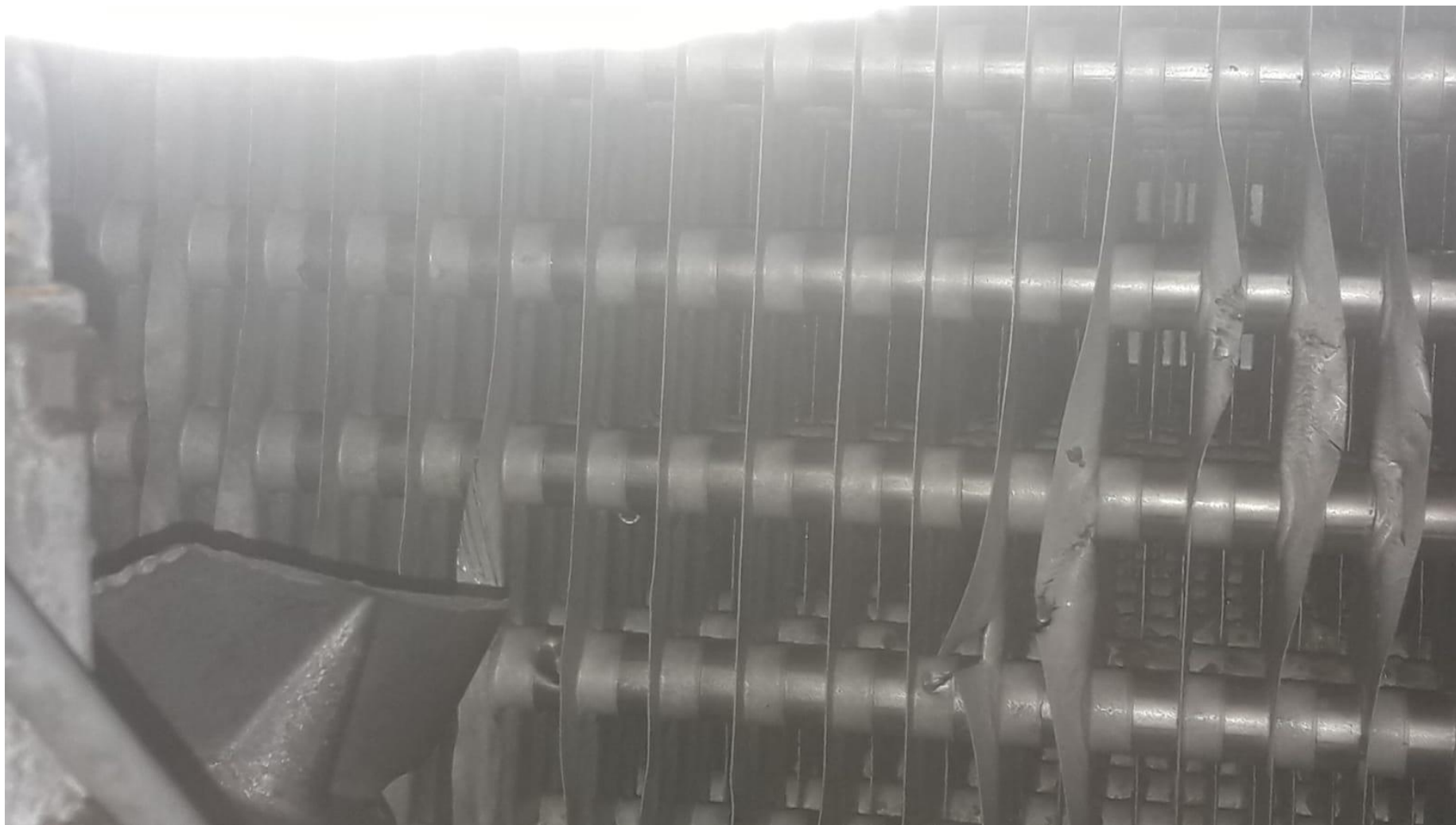
Kuva 6 (yritys): Rikkoutunut höyrystin (pakastuspiraali)
