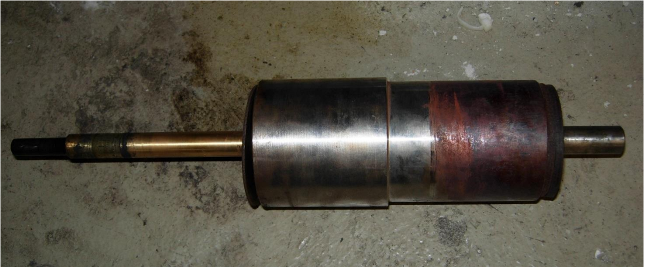
Kuva 5. Jarrun sähkömagneetin akseli.
