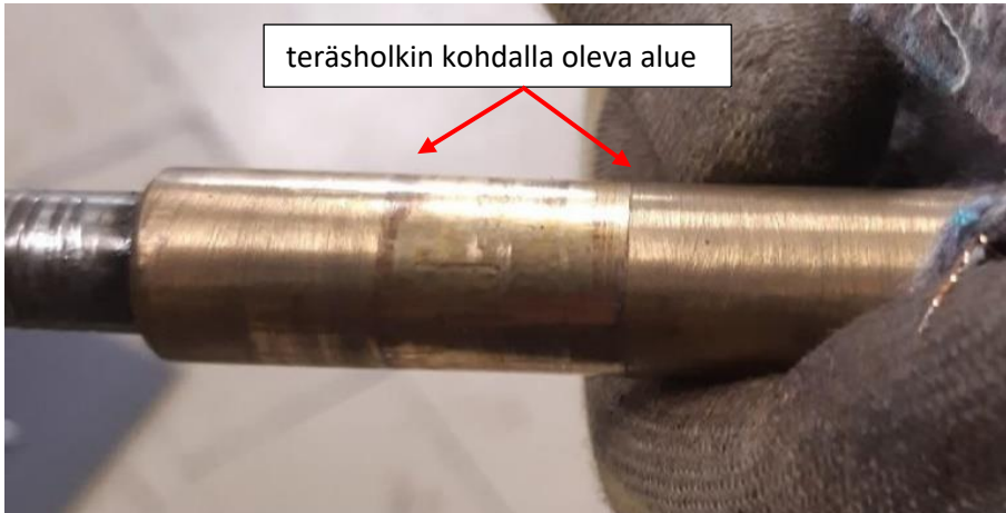
Kuva 9. Jarrun akselin messinkiä oleva jarrukenkien puoleinen pää.
